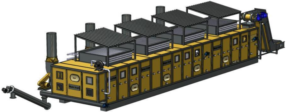
Şekil 1.7: Yonga levha bantlı kurutucu (URL-8, 2023.)
