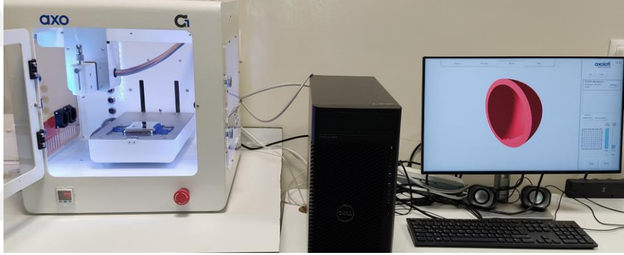
Fotoğraf 2.3. 3 boyutlu PCL membranların üretiminde kullanılan 3B yazıcı sistemi
