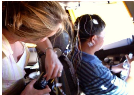
Şekil 3.16: Uçuş esnasında uygulanan polisomnografi cihazı ICAO-IATA-IFALPA (2011)'den alınmıştır.
