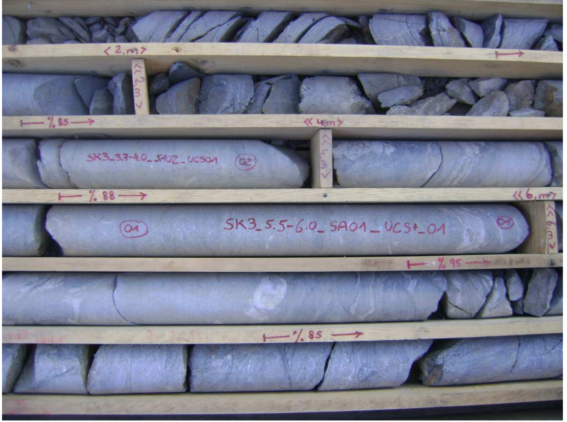
Şekil 4.13 : Laboratuvar deneyi için alınan metafiliz örneği (SK-3, 5,5-6 m).
