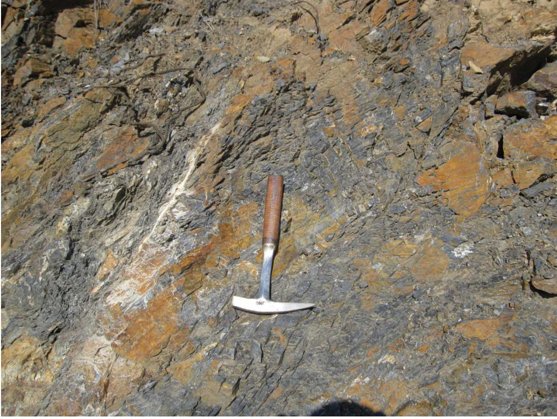
Şekil 4.6 : Heyelanlı bölgede yamaç molozunun altında bulunan metafiliz birimi.
