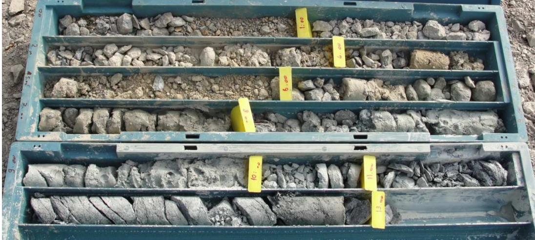
Şekil 4.12 : Yamaç molozu ve metafiliş birimi (HSK-3, 0-13 m).
