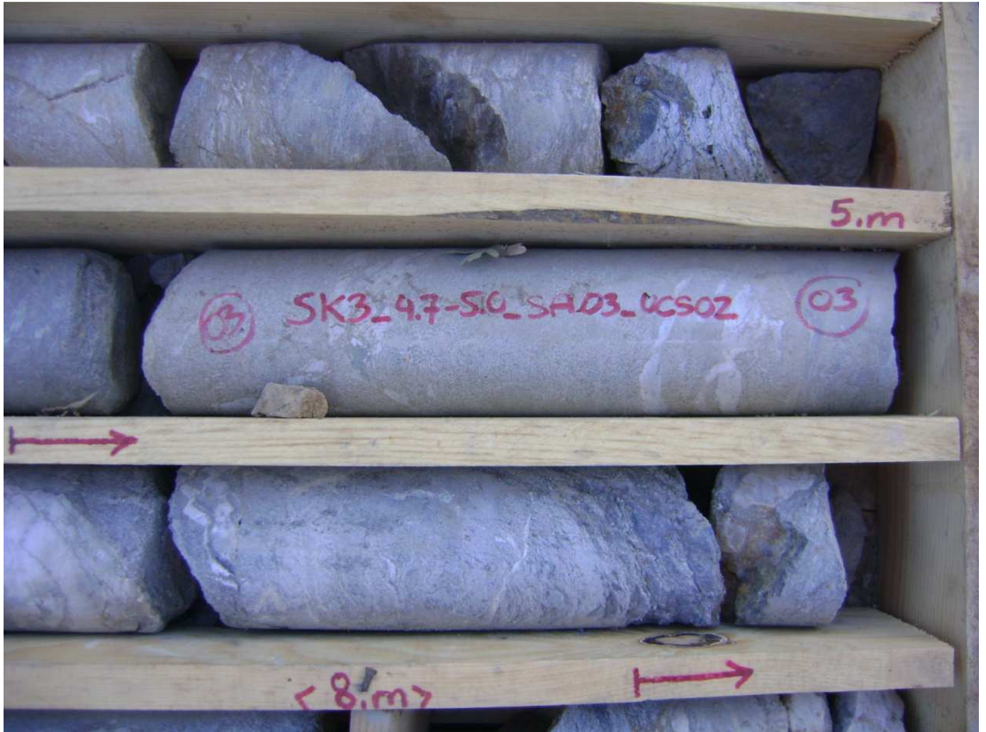
Şekil 4.14 : Laboratuvar deneyi için alınan metafiliz örneği (SK-3, 4,7-5 m).
