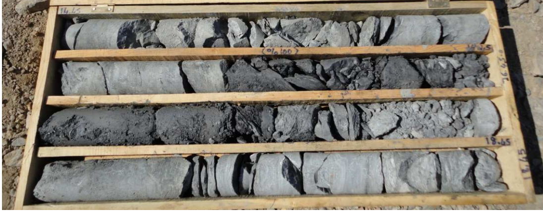
Şekil 4.11 : Metafiliş birimi (YHSK-2, 14,45-18,45 m).
