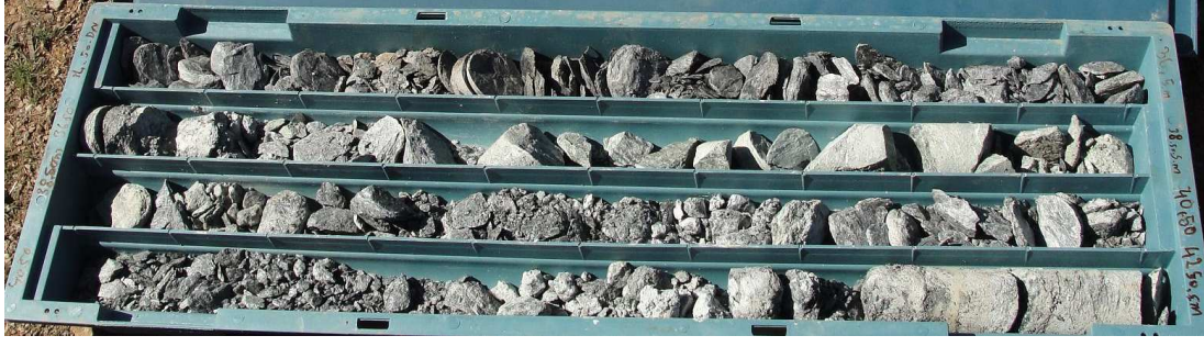
Şekil 4.10 : Metafiliş birimi (HSK-1, 34,5-42,5 m).
