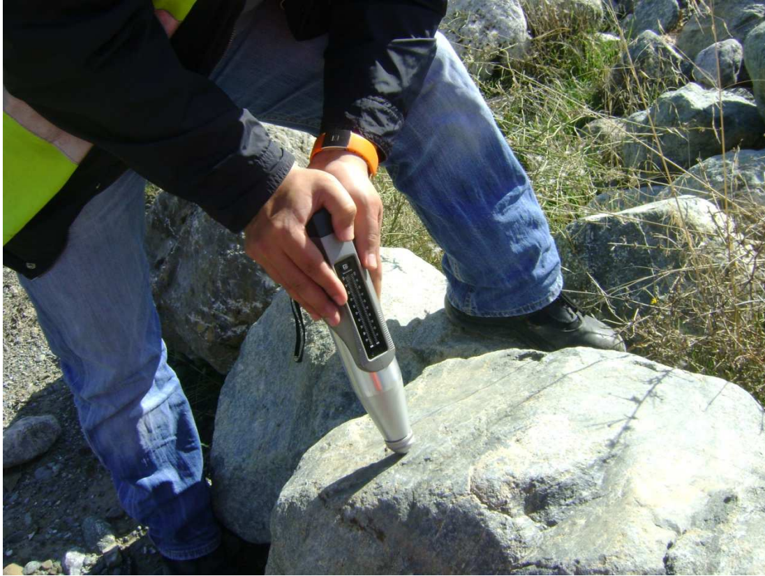
Şekil 4.9 : Uygulamanın yapıldığı schmidt çekici.
