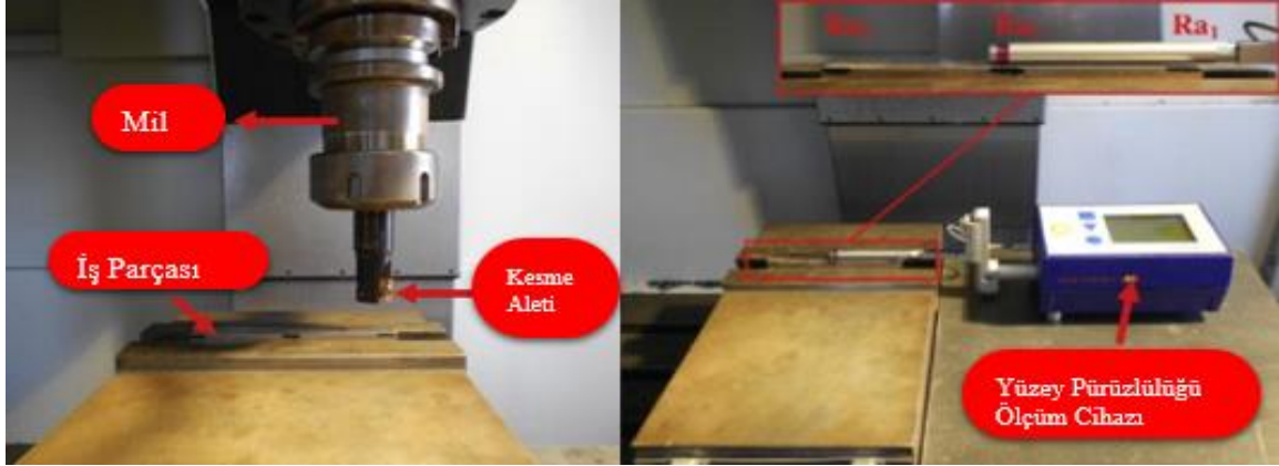
Şekil 2.1. Yüzey frezeleme testi için tasarlanan deney düzeneği ve yüzey pürüzlülüğü ölçümleri (Kıvak, 2014)
