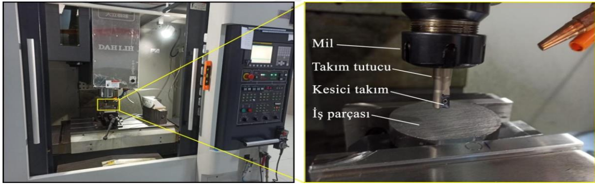
Şekil 2.9. Deneylerin gerçekleştirildiği CNC dik işleme freze tezgâhı (Şap, 2022)
