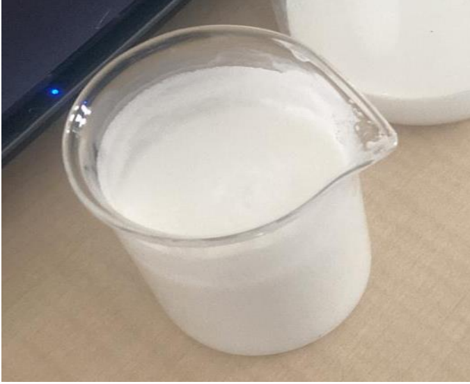
Şekil 6.16. MMY-Emülsiyon (mineral yağ + su) kesme sıvısının hazırlanışı
