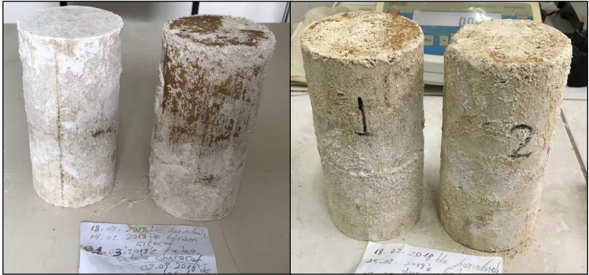
Şekil 29 Oda şartlarında bekletilen %10 NaOH çözeltili örneklerin görüntüleri.
