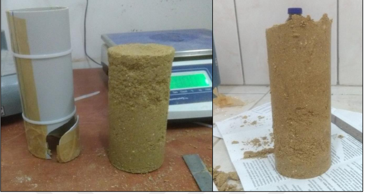
Şekil 26 Plastik kap kullanarak numune hazırlarken karşılaşılan olumsuzluklar.
