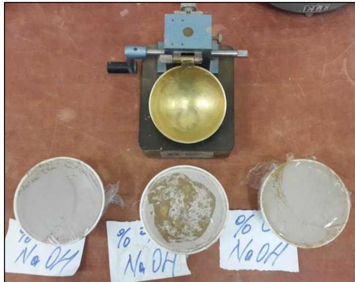
Şekil 17 Kürlenmesi için bekletilen likit limit numuneleri.
