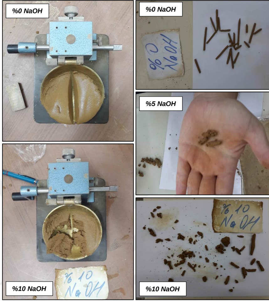
Şekil 18 Çözültüli örneklerin Atterberg limitleri deneylerine ait görüntüleri.
