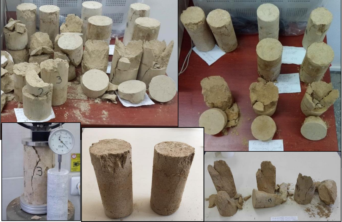
Şekil 35 Tek eksenli sıkışma dayanımı deneyi sonrasında bazı örneklerin görünümü.
