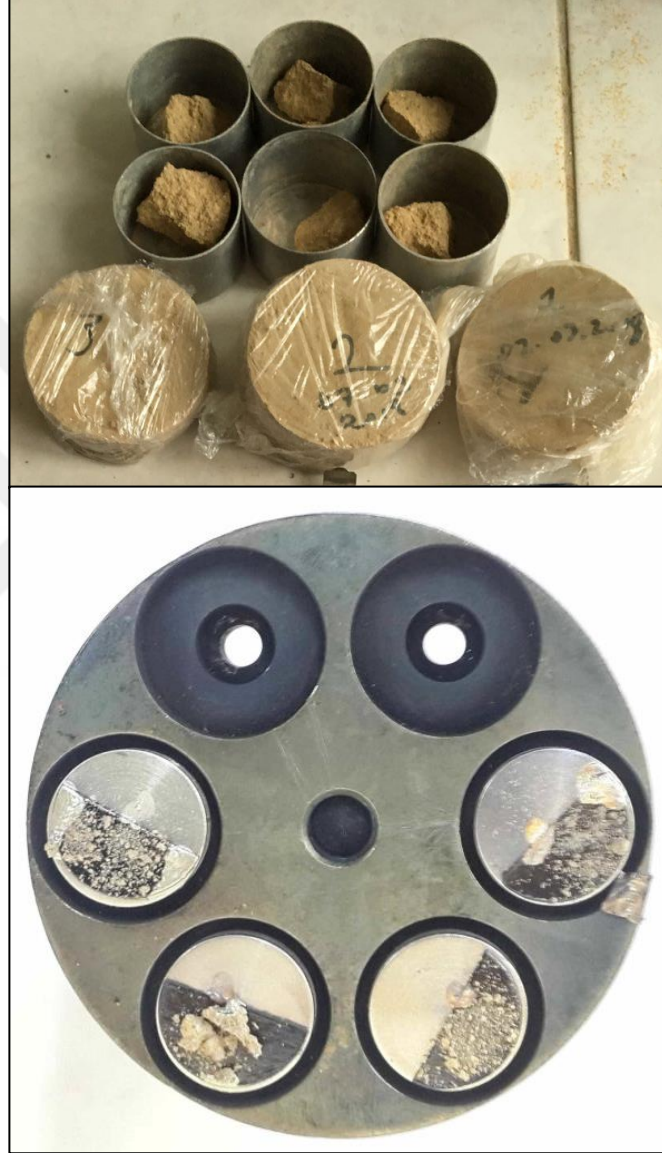
Şekil 70 SEM ve su içeriği tayini için alınan örnekler.
