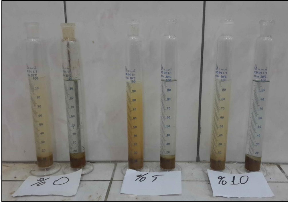
Şekil 25 Serbest şişme indeksi deneyi görüntüsü.
