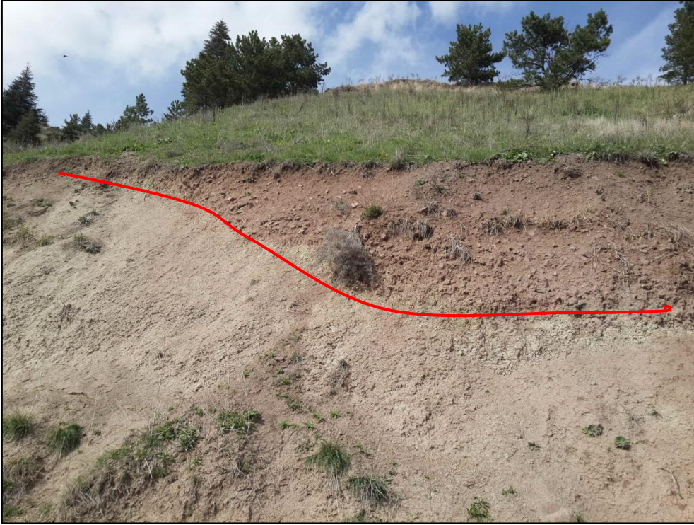
Şekil 8 Andezitik artık topraktaki renk geçişinin belirgin olduğu kısım.
