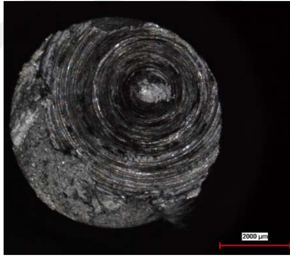
Şekil 4. 16. 190°C ısıt işlemlı AlSi10MgMn stereo mikroskop görüntüsü
