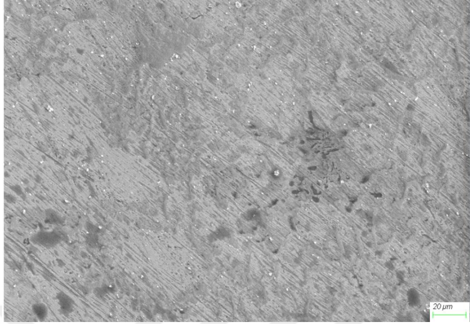
Şekil 4. 8. Isıl işlemsiz AlSi10MgMn SEM görüntüsü
