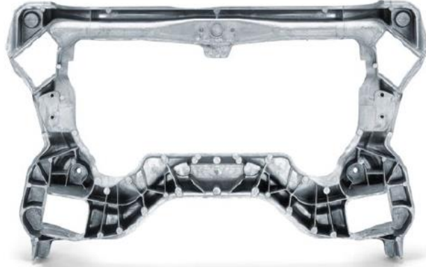
Şekil 2. 30. AlSi10MgMn alaşımı ile dökümü yapılmış motor beşiği [40]
