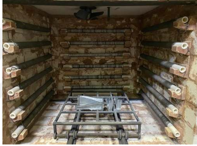
Şekil 3. 3. Numunelerin ısıt işlem fırını içerisindeki yerleşimi
