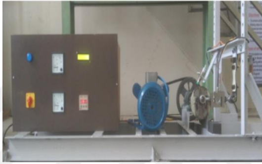
Şekil 2. 41. Uçak eğme yorulma testi için deneysel düzenek [44]
