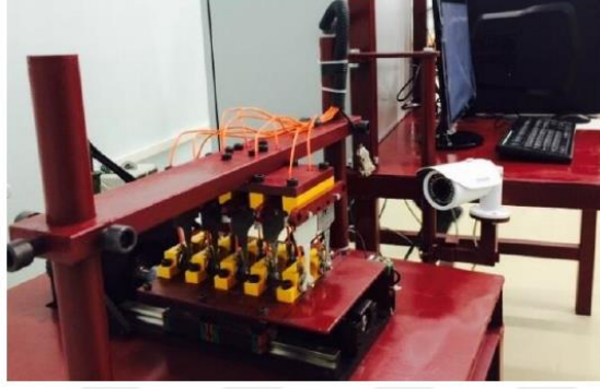
Şekil 2. 43. Çok numuneli ankastre tip eğilmeli yorulma cihazı [47]
