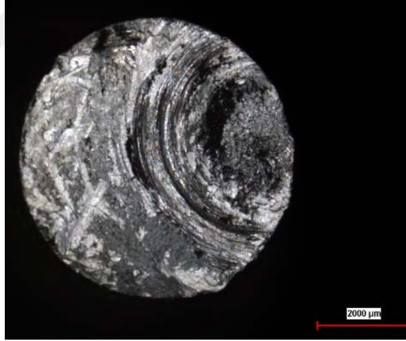
Şekil 4. 14. 170°C ısıt işlemli AlSi10MgMn stereo mikroskop görüntüsü
