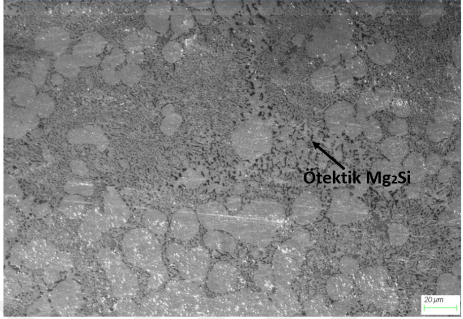
Şekil 4. 10. 180°C ısıtılmış AlSi10MgMn SEM görüntüsü
