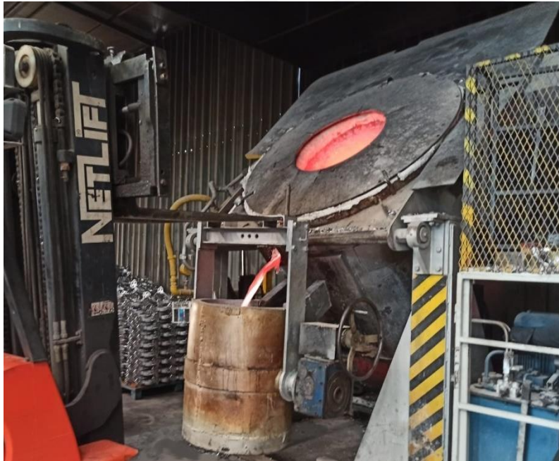
Şekil 4.14. Devirmeli ergitme fırını ile gerçekleştirilen ergitme prosesi.
