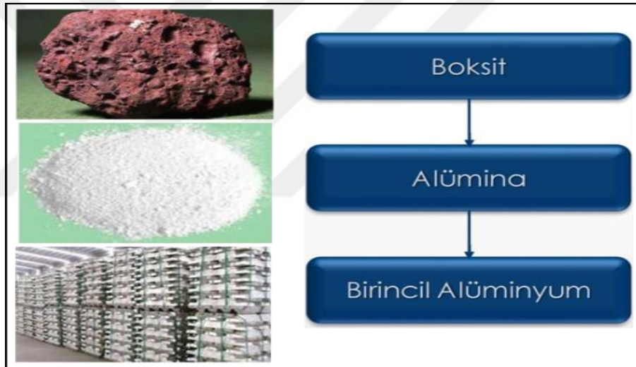
Şekil 2.4. Alüminyum üretimi aşamaları [17].
