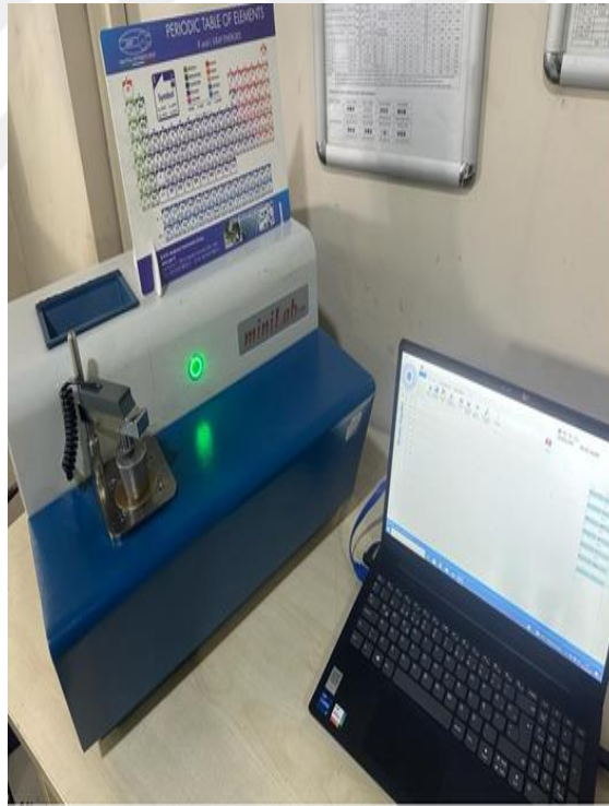
Şekil 4.8. GNR marka S1 MiniLAB 150 model spektrometre cihazı.
