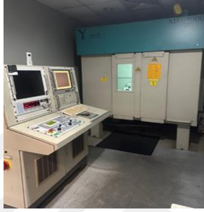
Şekil 4.11. YXLON MU 2000 (160 kW) marka radyoskopi cihazı.
