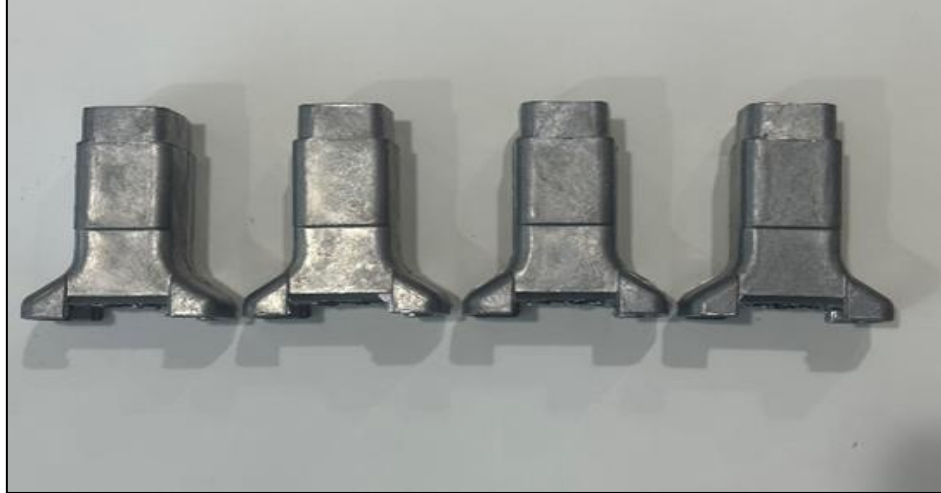
Şekil 4.18. NDT yöntemlerinden X-Ray muayenesi için hazırlanan numune görselleri.
