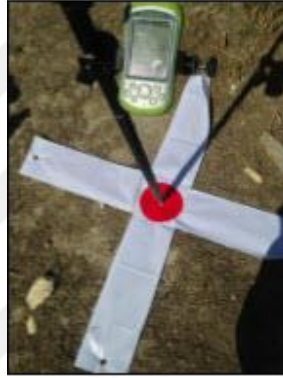
Şekil 4. 13. Yer kontrol noktası örneği (Avdan vd. 2014)
