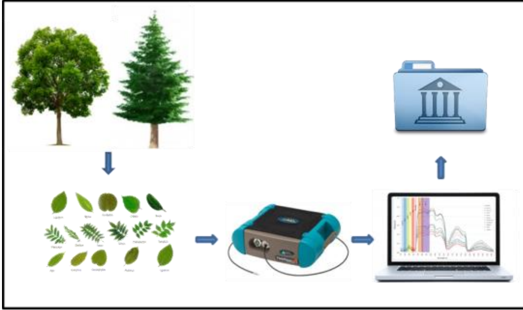
Şekil 3.6 : Spektral kütüphane oluşturulmasında takip edilen temel işlem adımları.
