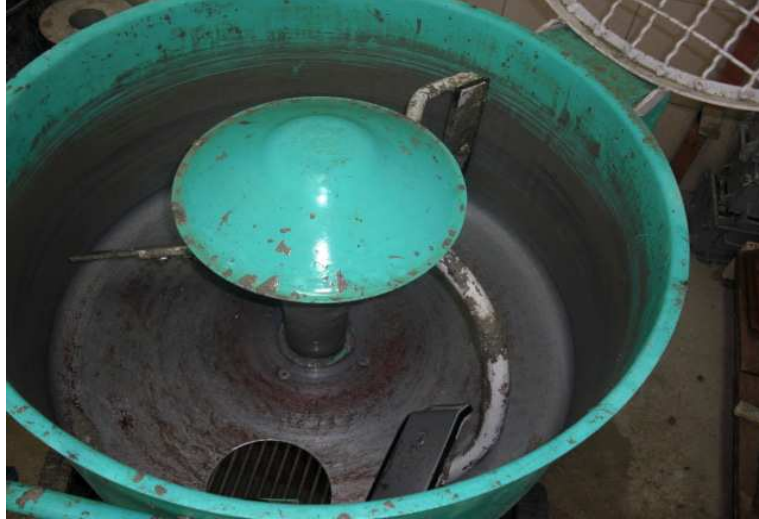
Resim 3.3 Beton karıştırıcı görünümü
