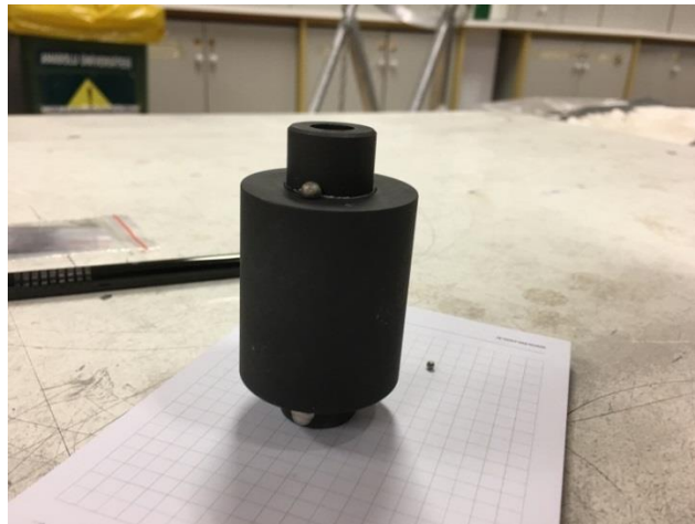
Görsel 4.1. Grafit kalıp içerisinde sinterleme sırasında eriyen numune görüntüsü.
