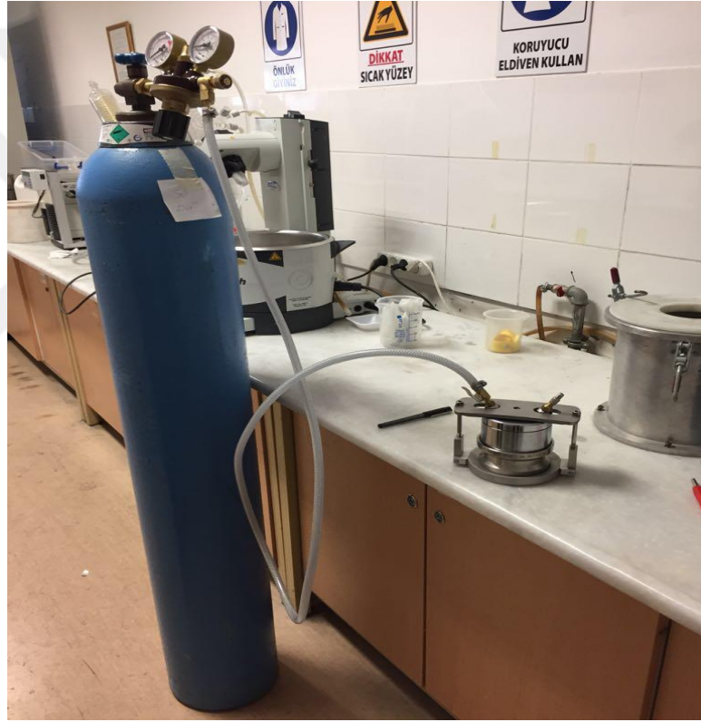
Görsel 3.1. Öğütme haznesinin Ar gazı ile doldurulması.
