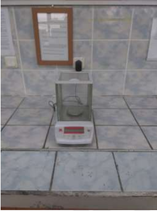
Resim 3.9. Elementlerin tartımı için kullanılan hassas terazi
