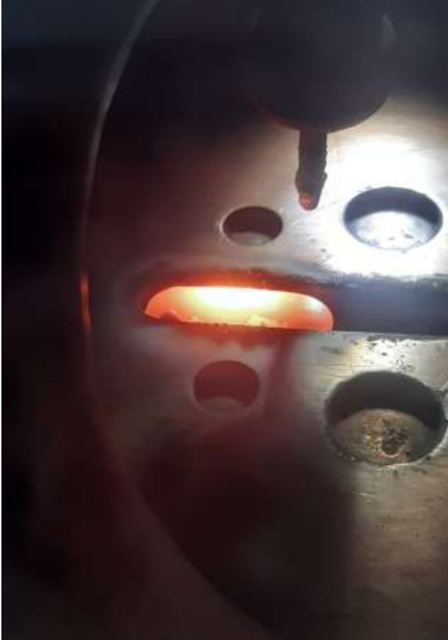
Resim 3.12. Ark ergitme yöntemiyle oluşturulan numuneler
