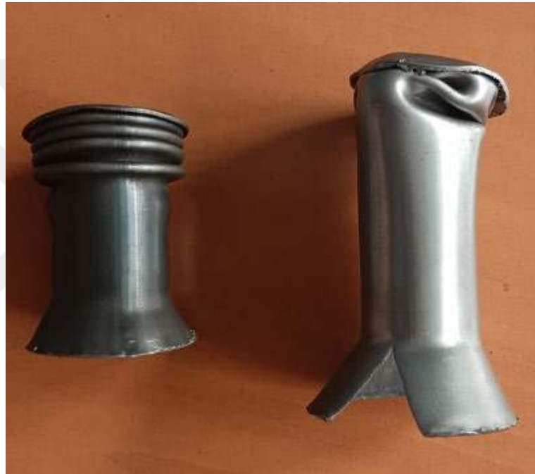
řekil 6.4. 6112 tipi numunelere 550°C gerilim giderme tavlaması sonucu uygulanan geniřletme testi.
