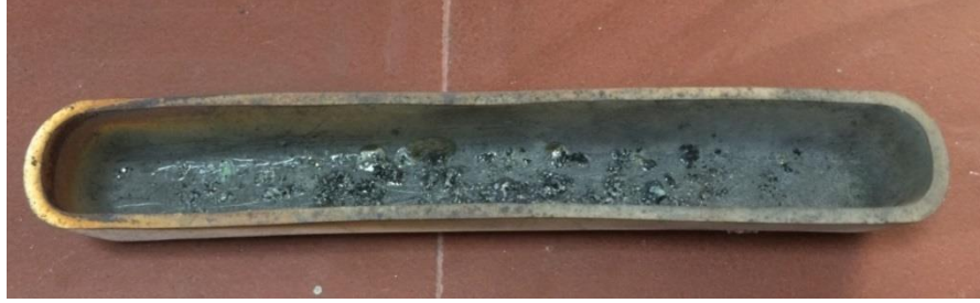
Şekil 6.6: 1250 °C’de, %150 stokiyometrik C oranında, 2 saat deney süresinde yapılan redüksiyon işleminde kullanılan kayıkçık.
