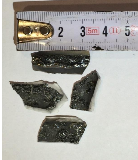
Şekil 6.7: 1250 °C’de, %150 stokiyometrik karbon oranında, 2 saat deney süresinde yapılan redüksiyon işleminde kullanılan kayıkçıktan kırılarak alınan SEM numuneleri.
