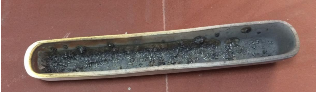
Şekil 6.2: 1300 °C’de, %150 stokiyometrik C oranında, 1 saat deney süresinde yapılan redüksiyon işleminde kullanılan kayıkçık.
