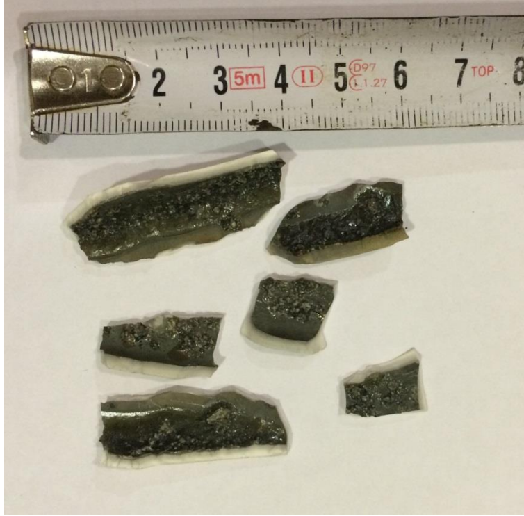
Şekil 6.3: 1300 °C’de, %150 stokiyometrik C oranında, 1 saat deney süresinde yapılan redüksiyon işleminde kullanılan kayıkçıktan kırılarak alınan SEM numuneleri.
