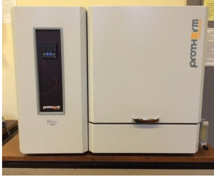
Şekil 5.8: Elektrik direnç fırını.
