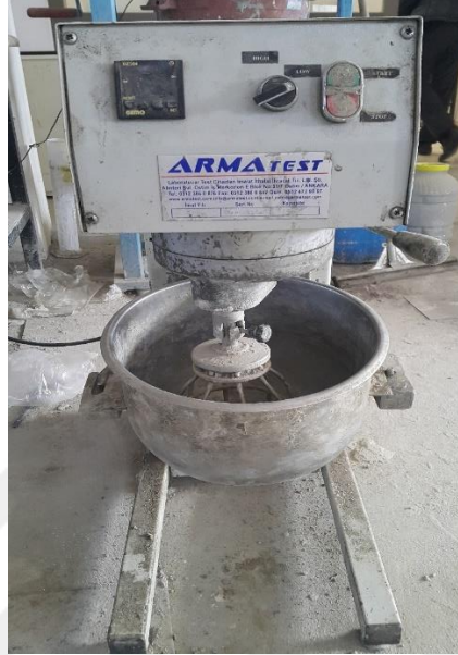
Şekil 3.7: Beton beton mikseri
