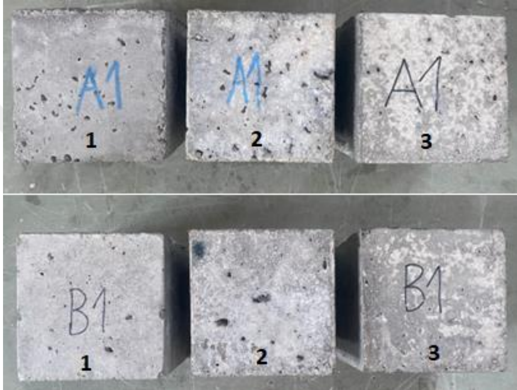
Şekil 4.1. Kontrol numunelerin 90 günlük kür sonunda görünüşleri (1; Standart kür, 2; %5 Na_2SO_4 çözeltisi, 3; %5 MgSO_4 çözeltisi)
