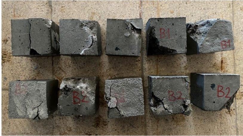
Şekil 4.2. Standart kür esnasında çatlayan cürufllu numuneler.
