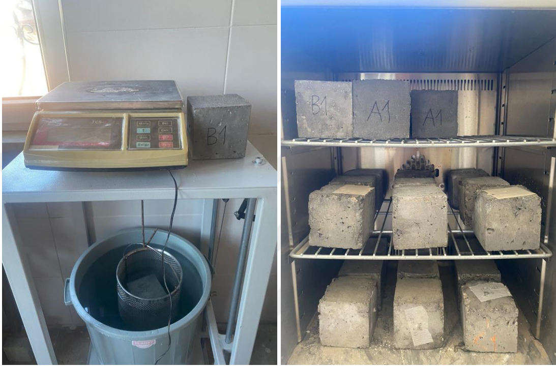
Şekil 3.13. Sertleşmiş betonda su emme deneyine ait görseller.
