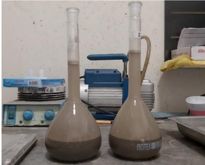
Şekil 3.7. İnce agregalar için özgül ağırlık deneyi.
