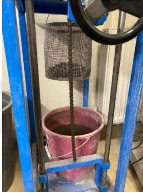
Şekil 3.6. Kaba agreganın sudaki ağırlığının ölçümü.
