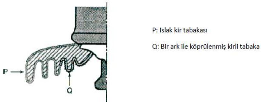
Şekil 3.6. Kuru band oluşmuş kirli izolatör
