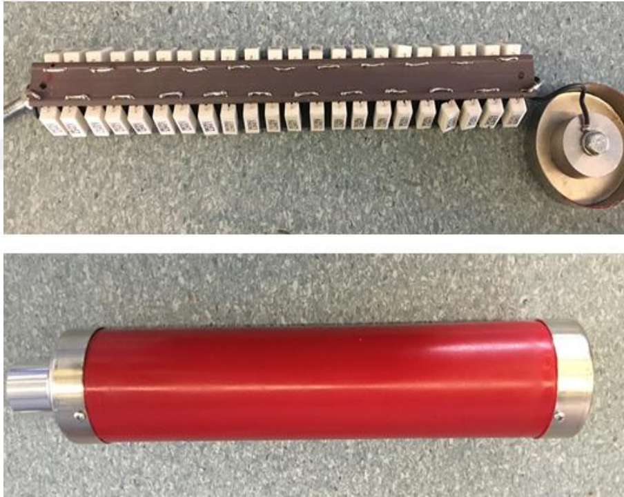
Şekil 5.8. Ön direnç içyapısı ve tamamlanmış hali
