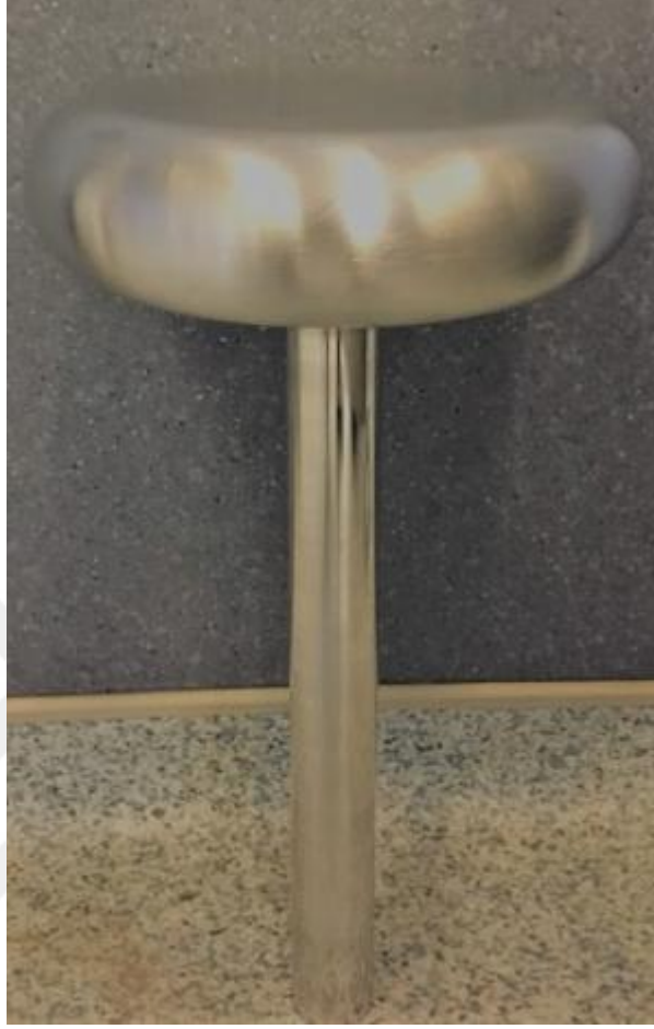
Şekil 5.1. Tasarlanan yüksek gerilim elektrotunun resmi
