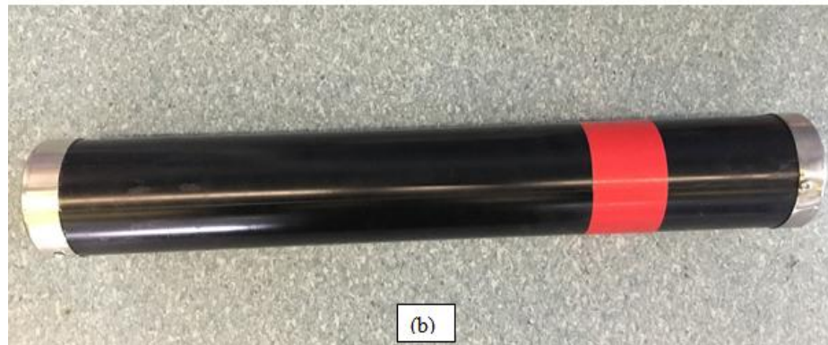
řekil 5.13. Dođrultucu blođu a) iyapısı b) tamamlanmıř hali
