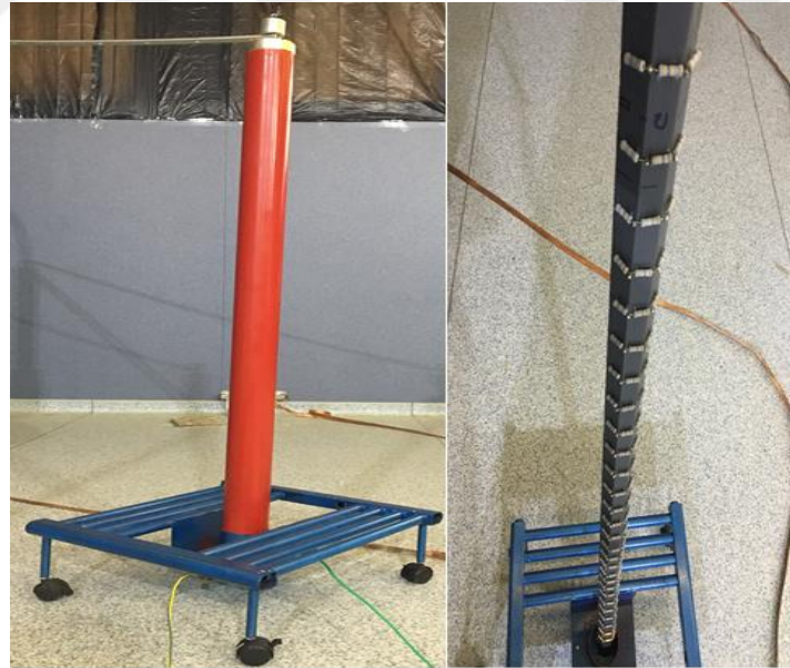
Şekil 5.10. Gerilim bölücü içyapısı ve tamamlanmış vaziyeti
