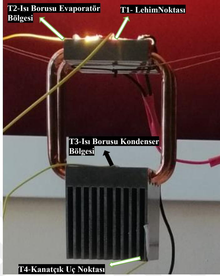
Şekil 3.7. Isı borulu soğutucu ünite sıcaklık ölçüm noktaları.
