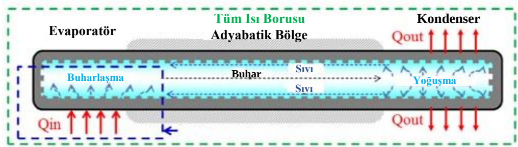
Şekil 2.4. Düz plakalı ısı borusu (Chen vd., 2017).
