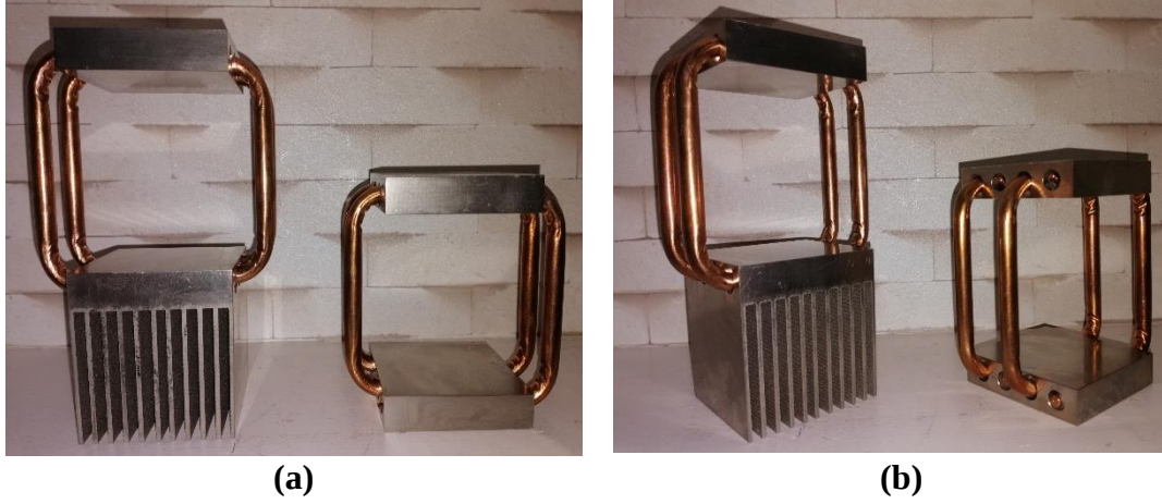
Şekil 3.5. Prototipi imal edilen ısı borulu soğutucu ünite.
