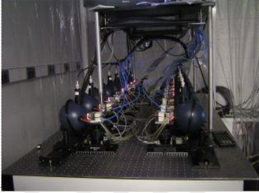
Şekil 13. Optik masa üzerinde örnek bir lazer diyot test sistemi.
