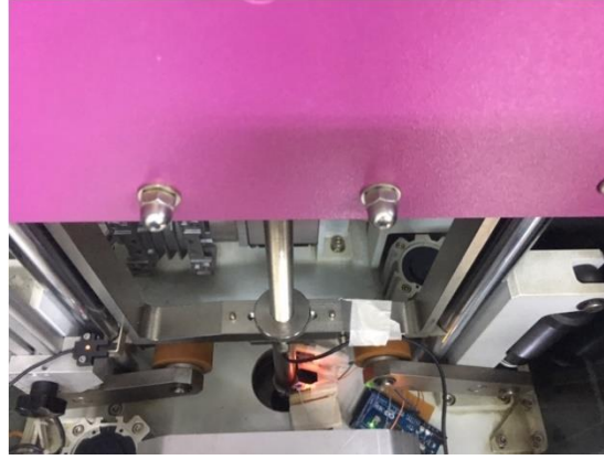
Şekil 3.7 Düşen ağırlık darbe test cihazında optik ölçüm sisteminin yerleştirilmesi (Karpuz ve Gören, 2019)
