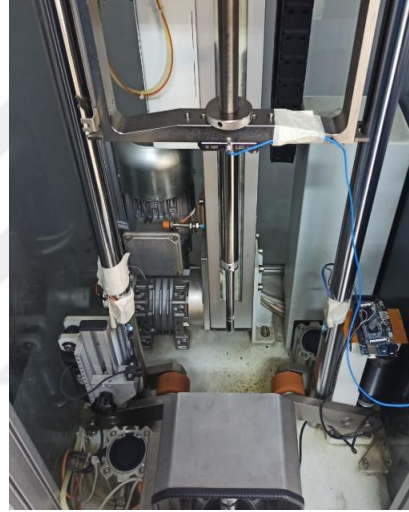
Şekil 3.8 Düşen ağırlık darbe test cihazında optik ölçüm sisteminin yerleştirilmesi (Kişisel arşiv, 2021)
