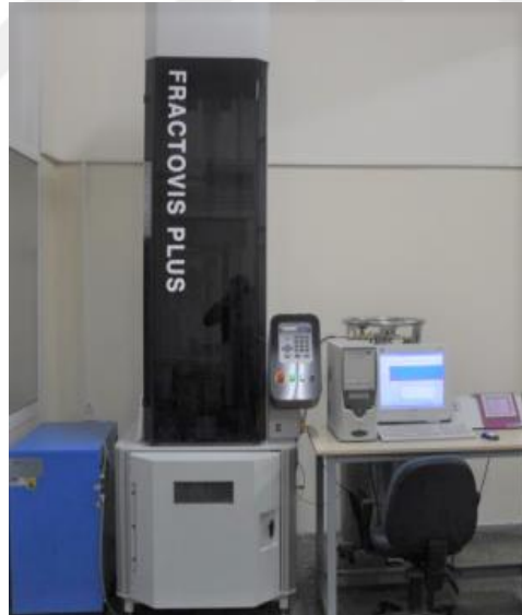
Şekil 3.6 Çalışmada kullanılan düşen ağırlık darbe test cihazı (Karpuz ve Gören, 2019)
