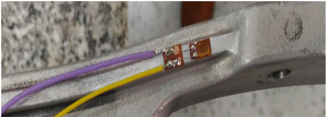
Şekil 3.17 Salıncak ile gerinim sensör deneği (Kişisel arşiv, 2020)
