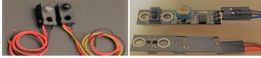
Şekil 3.3 Deneysel olarak kullanılan optik sensörler: a) Kızılötesi bariyer sensör b) TCRT5000 kızılötesi yansıtıcı sensör modülü (Kişisel arşiv, 2018)
