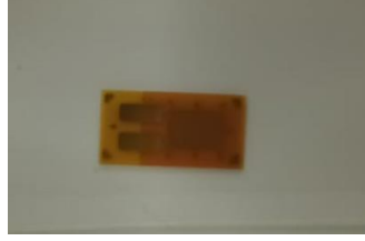
Şekil 3.12 Strain-gage örneği (Kişisel arşiv, 2018)
