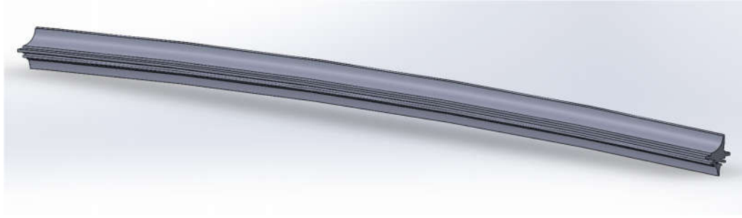
Şekil 3.1 : Kullanılan orijinal silecek geometrisi.
