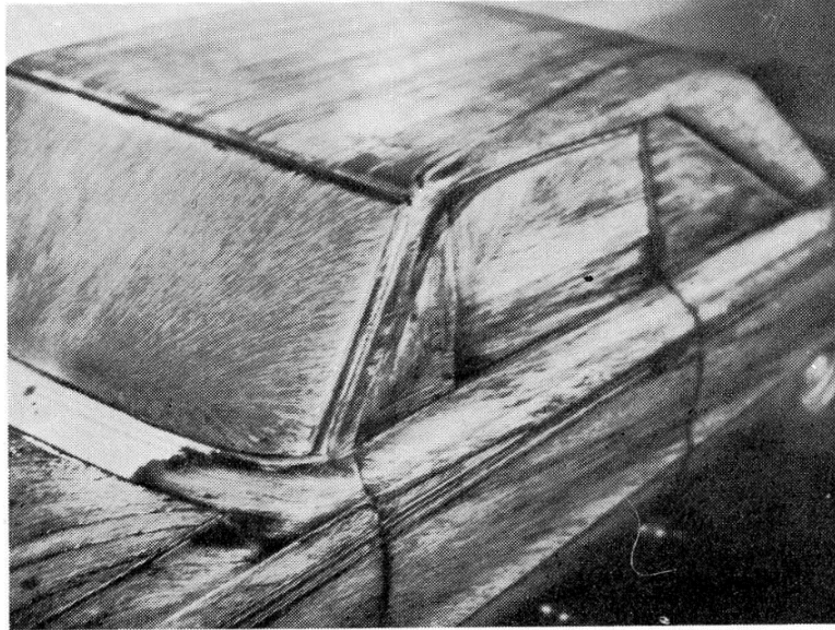
Şekil 2.6 : 3/8 model için 120 km/h hız için akış görselleştirmesi [4].
