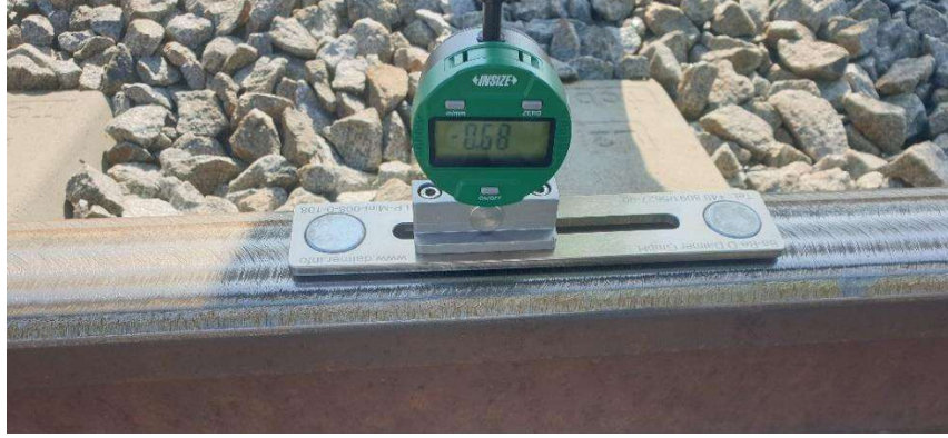
Görsel 3.13. Taşlama öncesi dijital derinlik ölçüm
