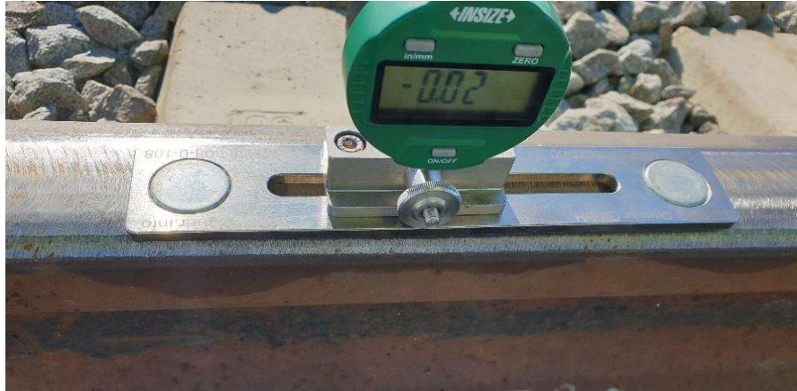
Görsel 3.14. Taşlama sonrası dijital derinlik ölçüm
