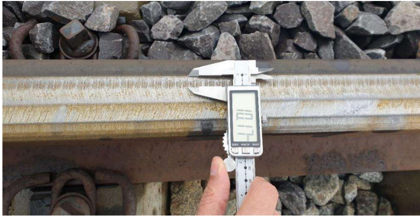
Görsel 3.11. Taşlama sonrası ray profili taşlama izleri ölçümleri
