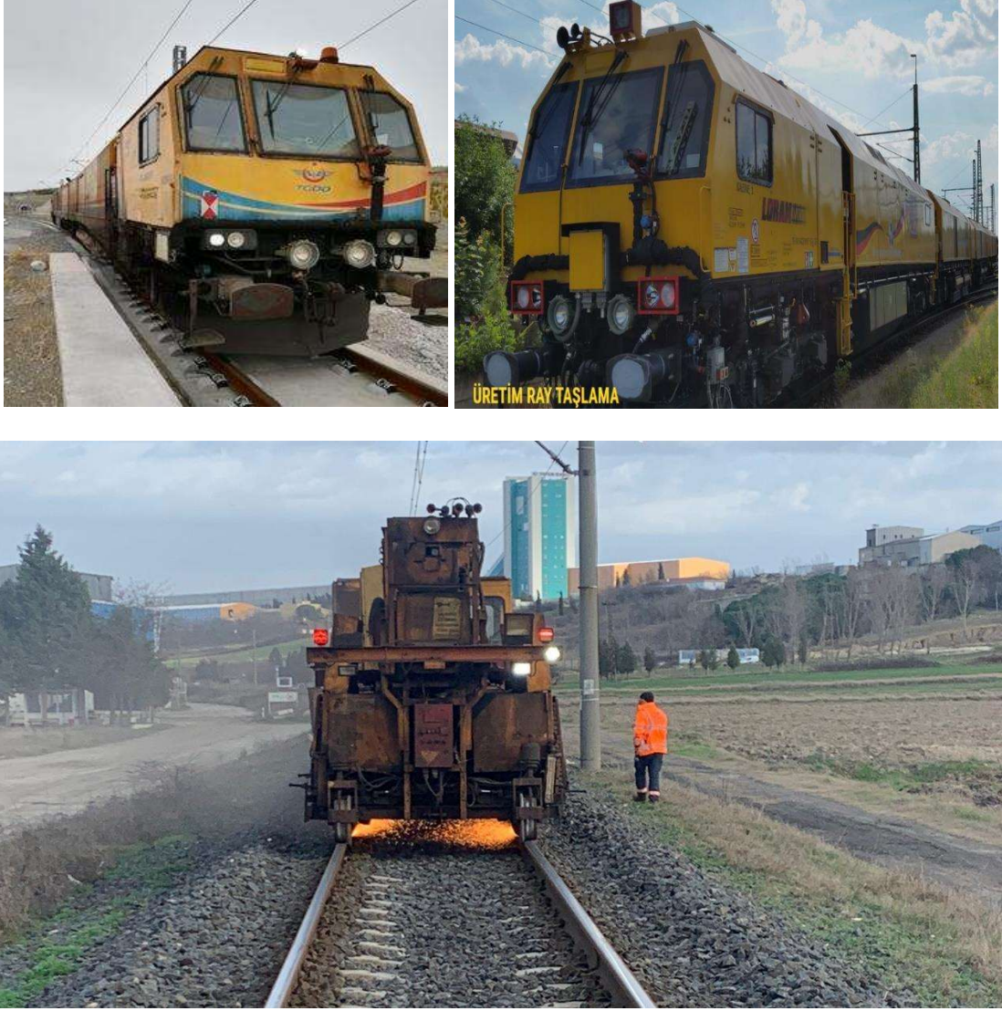
Görsel 2.1. LORAM RGI-8 ray taşlama makinesi (Loram, 2023)
