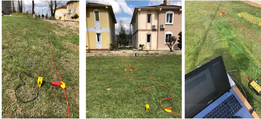
Şekil 2.3. Sismik Kırılma ve MASW arazi deneylerinin yapıları [47]
