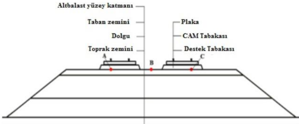
Şekil 2.24 Pekin-Şangay çift hatlı düşük dolgulu yüksek hızlı balastsız döşeme raylı demiryolu üstyapı kesiti (Chen and Zhou 2018).
