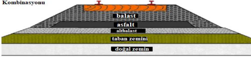
Şekil 2.8 Altbalast tabakasında Asfalt kombinasyonu kullanılmış demiryolu üstyapısı.
