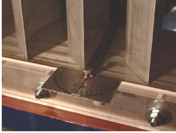
Şekil 2.5 : Profil açısını konumlandırılması (Wosnik ve Arndt, 2006).
