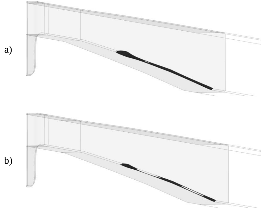
Şekil 4.43 : 2 m/s akış hızı için ayrılma hadisesi; Vaka a) 32*, b) 33*.
