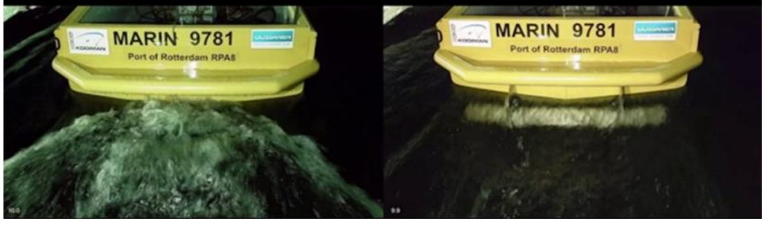
Şekil 1.10. 108 m offshore gemi modelinin gövde kanadı monte edilmemiş ve edilmiş haldeki uygulamaları (Bouckaert vd., 2018).
