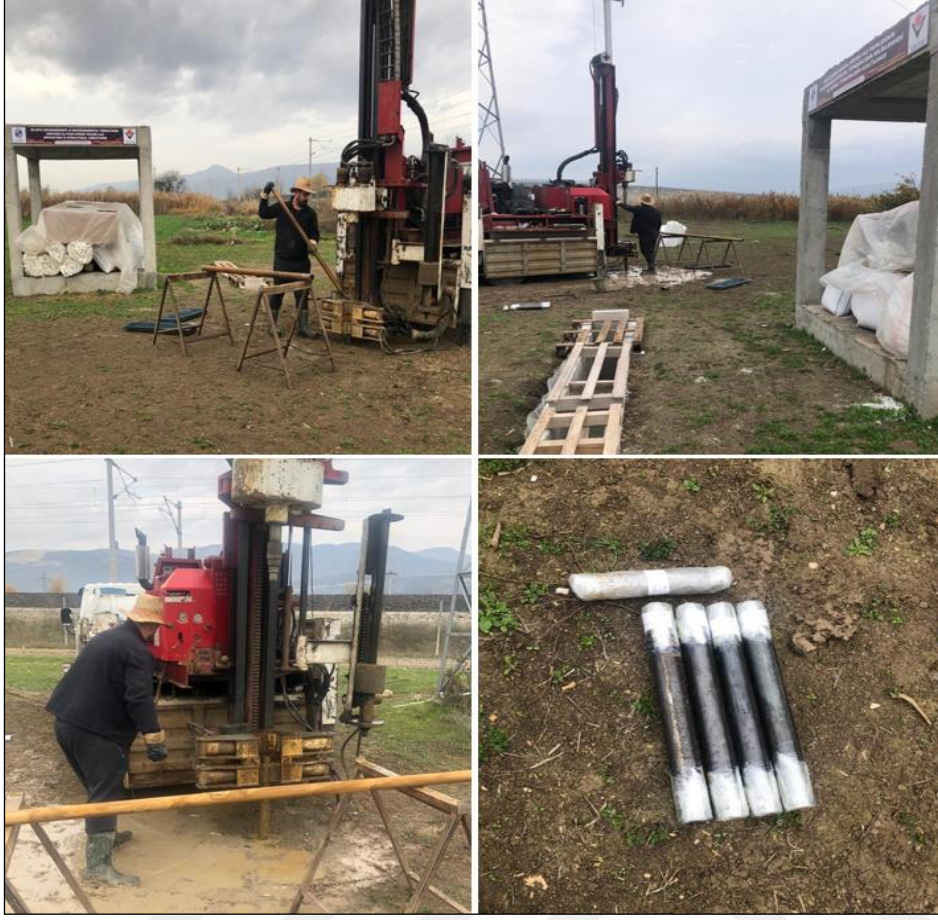
Şekil 3.4. Test sahasında yapılan sondaj çalışması ve araziden alınan UD örnekleri.
