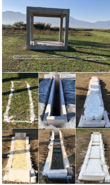
Şekil 3.43. Bariyerli durumda bina titreşim ölçümleri için test edilen farklı dolgu malzemeli dalga bariyerleri
