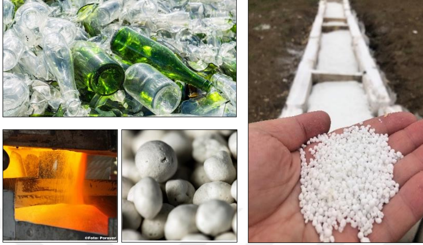
Şekil 3.30. Geri dönüştürülmüş malzemeden üretilmiş genleştirilmiş cam kürecik.
