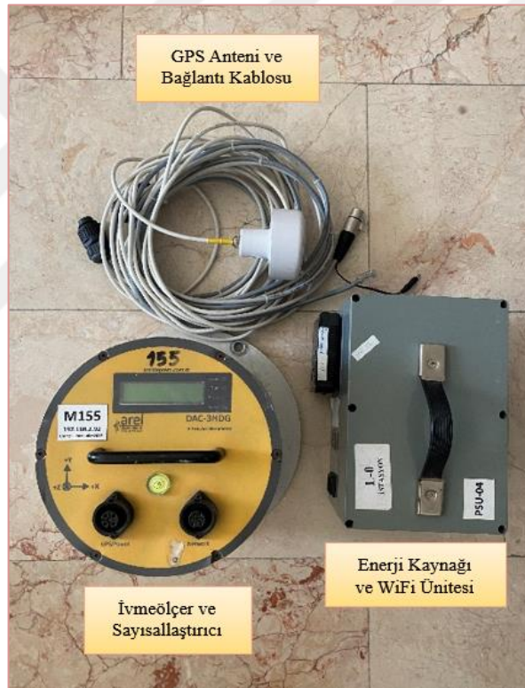
Şekil 3.5. Saha ölçümlerinde kullanılan deney seti.
