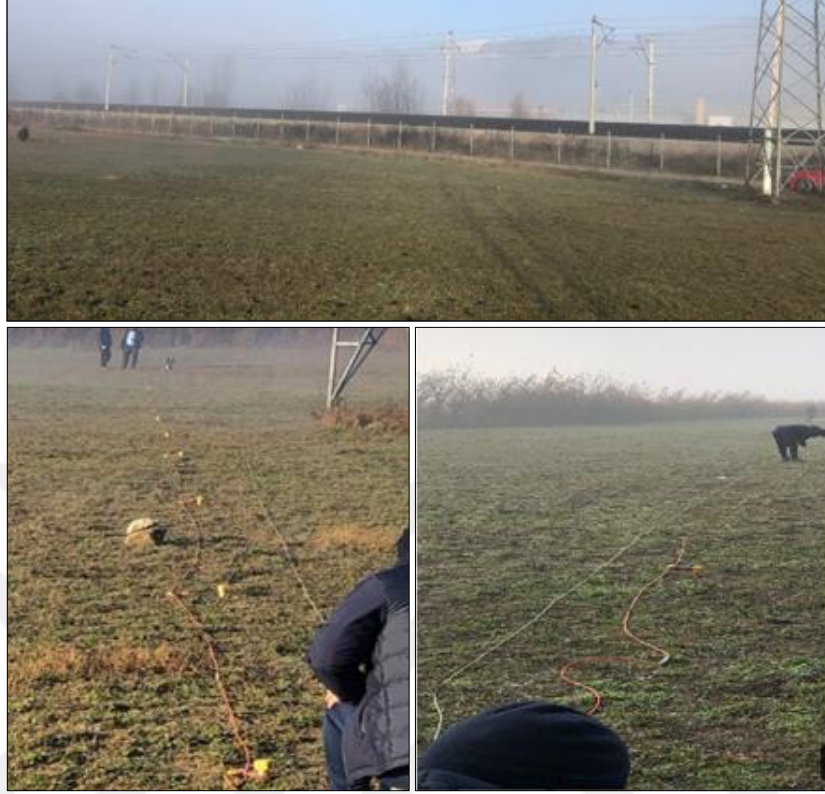
Şekil 3.2. Arazinin iki dik doğrultusunda sismik (MASW) testlerin uygulanması.
