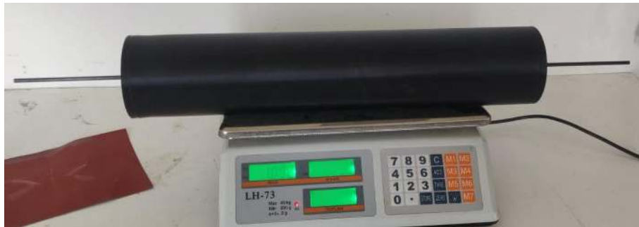
Şekil 3.3. 3D yazıcıda üretilen 10x50 cm ebatlarındaki silindir
