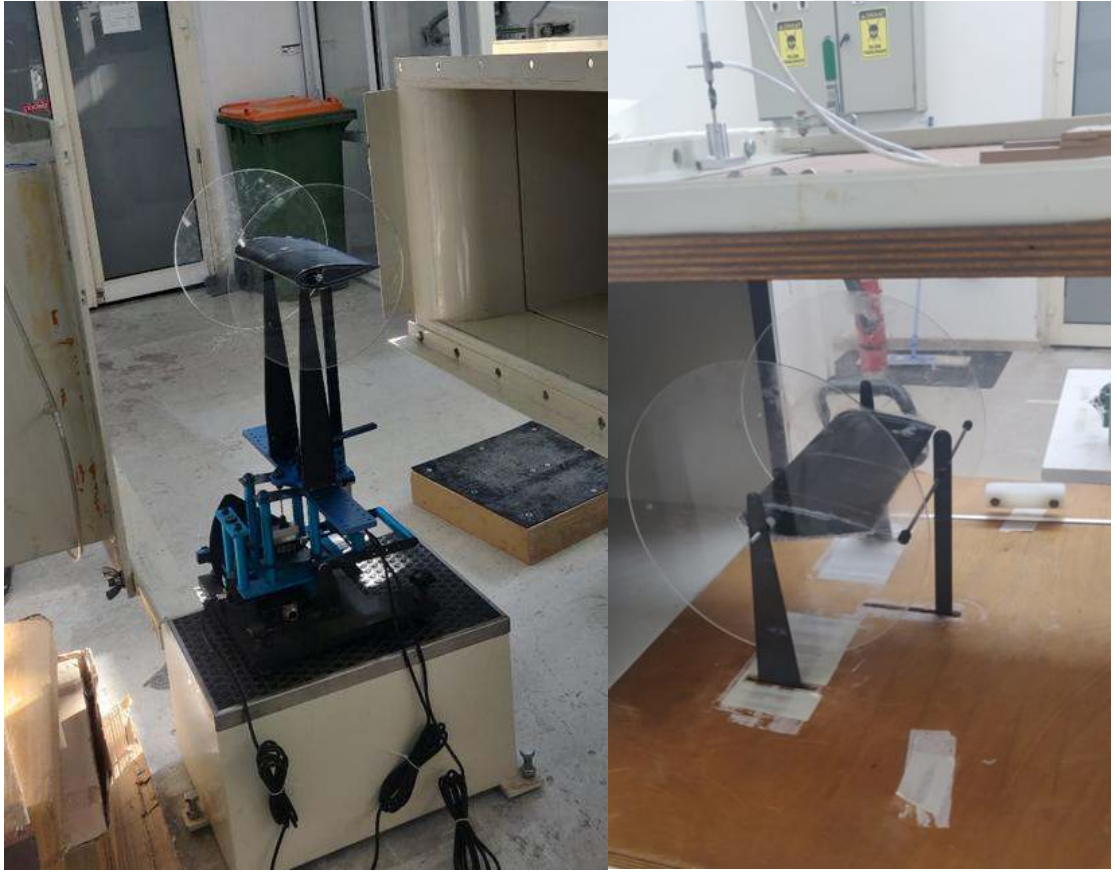
Şekil 3.11. NACA0024 kanat profilinin balans mekanizması ile test odasına yerleştirilmesi
