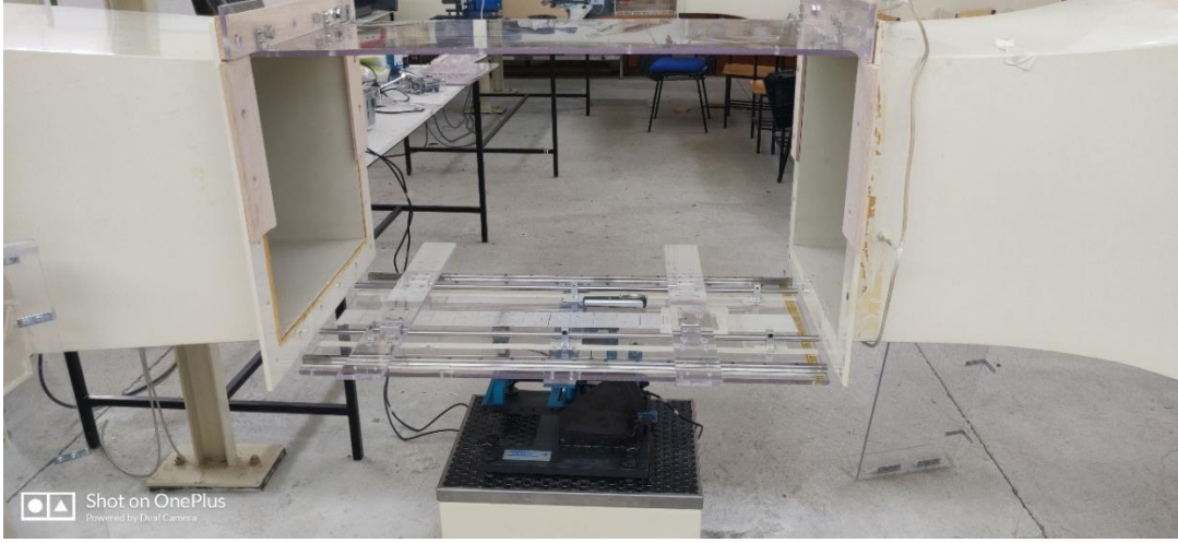
Şekil 2.15. Rüzgâr tüneli test odasına alt platformun konumlandırılması aşaması
