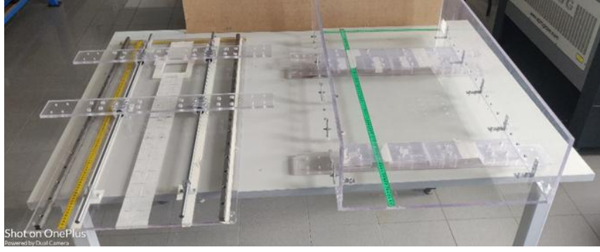
Şekil 2.12. Rüzgâr tüneli test odası alt platform tasarım aşaması
