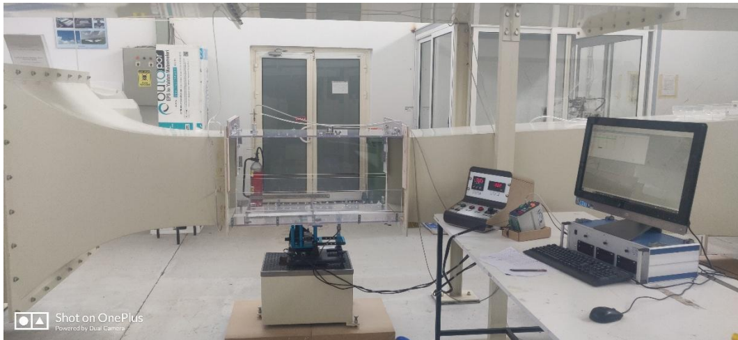
Şekil 2.9. Rüzgâr tüneli test odasına konumlandırılan birinci deney düzeneği
