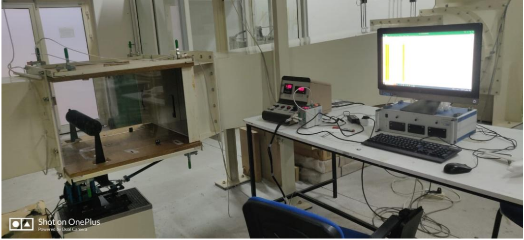
Şekil 3.5. Balans mekanizması ile rüzgâr tüneli test odasına konumlandırılan silindir ile ölçüm yapılması
