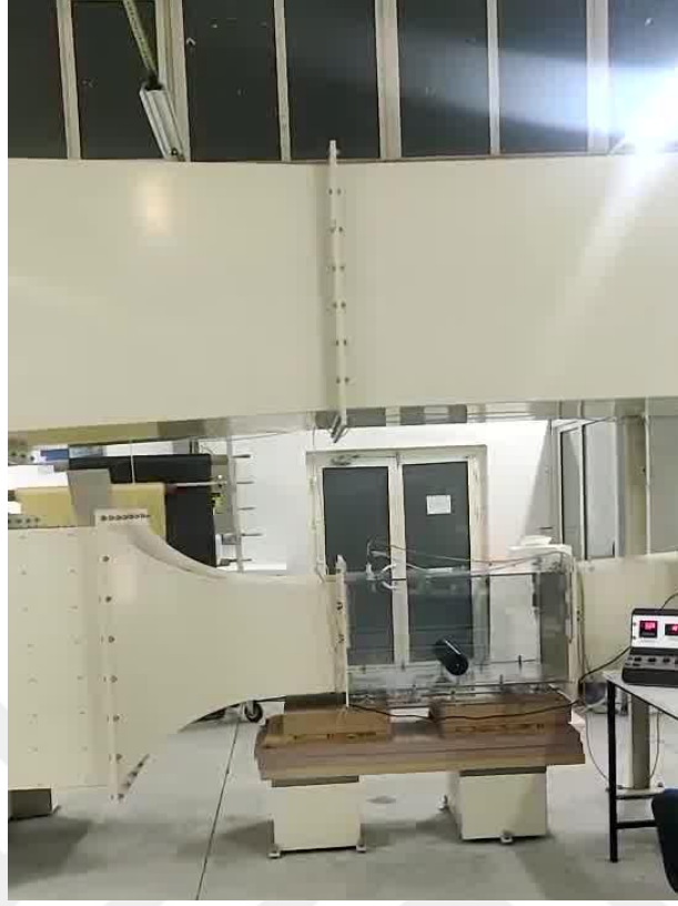
Şekil 3.6. Üçüncü deney düzeneği ile silindirin rüzgâr tüneli test odasına konumlandırılması
