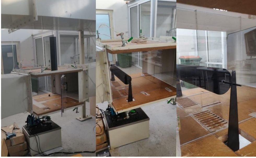
Şekil 3.4. Balans cihazı ile silindirin rüzgâr tüneli test odasına konumlandırılması aşaması
