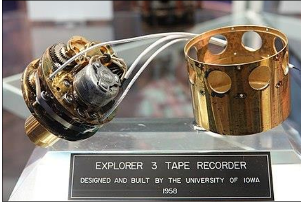
Resim 2.5. Explorer 3 uzay aracı ses kayıt cihazı görüntüsü [18]
