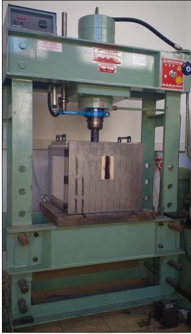
Resim 6.4. Numune şekillendirmesi için kullanılan tek etkili presleme cihazı
