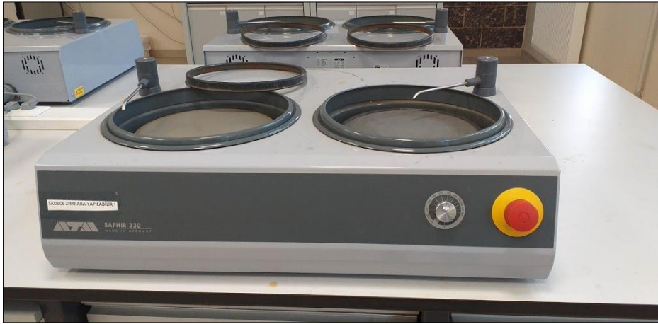
Resim 6.9. Zımparalama işleminin yapıldığı cihaz
