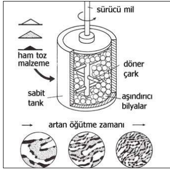
Şekil 2.3. Mekanik alaşımlama öğütme yöntemi [27]
