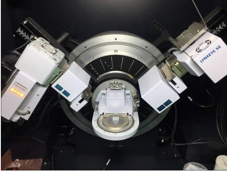
Resim 6.13. XRD analizinde kullanılan Lynxeye XE markalı dedektör
