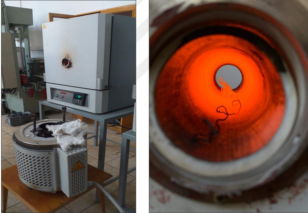
Resim 6.8. Isıl işlem ve martemperleme işlemi için kullanılan tuz banyosu düzeneği
