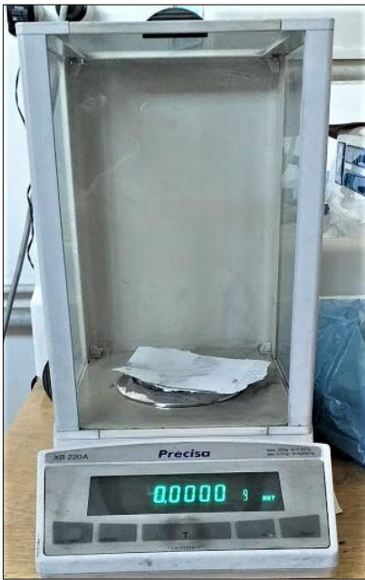
Resim 6.7. Yoğunluk ölçümlerinde kullanılan dijital terazi
