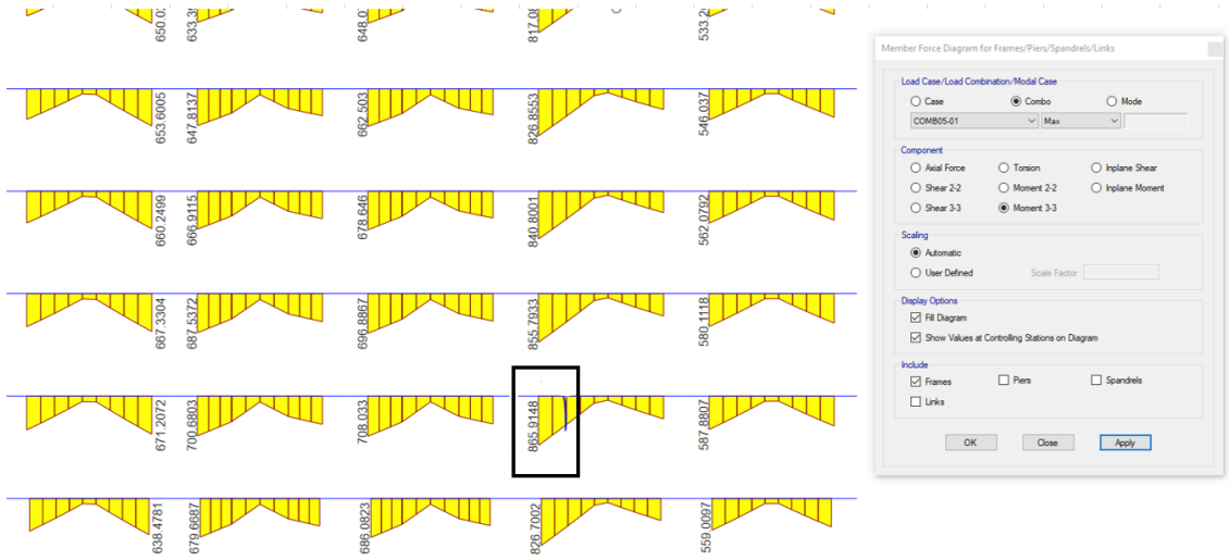
Şekil 4.35. Kritik kompozit kirişlere ait moment diyagramları
