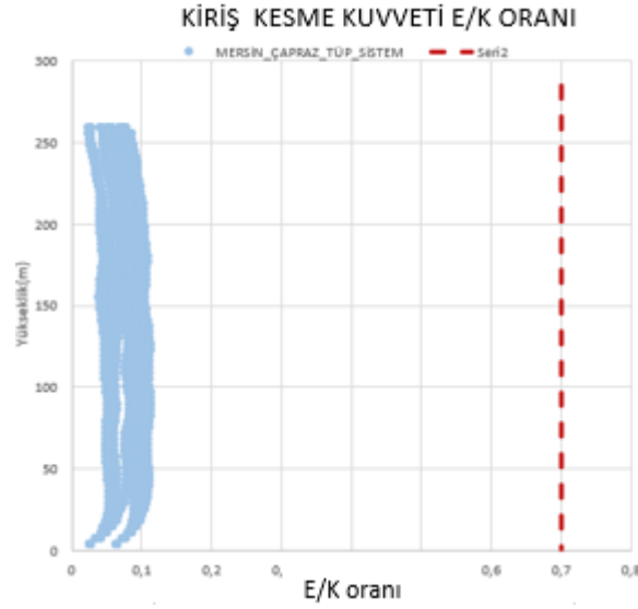
Şekil 4.40. Kiriş elemanlardaki kesme kuvvetleri için talep/ kapasite oranı
