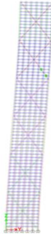
Şekil 5.46. Mersin ve Hatay çaprazlı kafes tüp sistemlerinde Van depremi durumunda meydana gelen hasar bölgeleri
