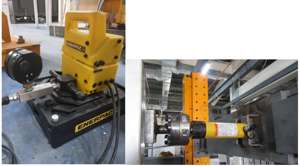
Şekil 3.2. Hidrolik pompa, piston ve yük hücresi
