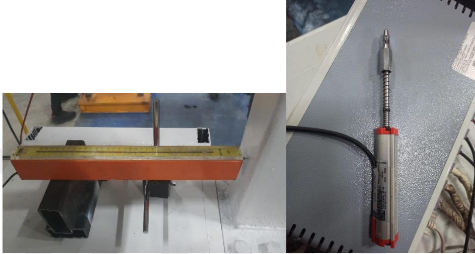
Şekil 3.1. Dijital deformasyon ölçme cihazı (LVDT) ve Doğrusal yer değiştirme sensörleri (Potansiyometre).
