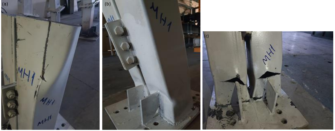
Şekil 4.21. MH1 numunesinin göçme modları (a) ezilme, (b) burkulma, (c) yırılma
