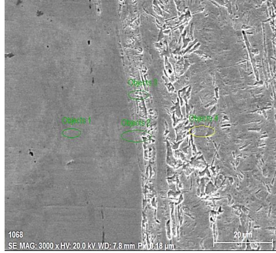
Şekil 4.20 S4 no'lu numunenin EDS analiz sonuçları.
