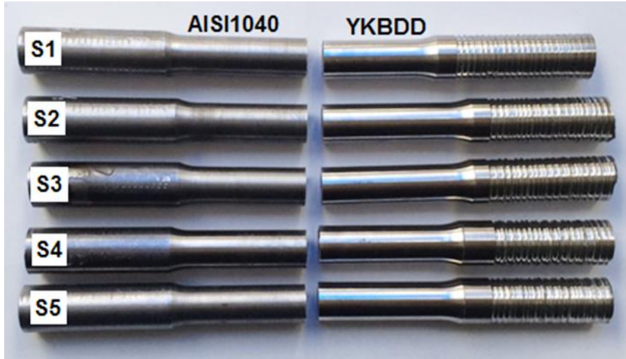
Şekil 4.26 S1-S5 kaynaklı bağlantılara ait çekme test numunelerinin çekme testi sonrası makro fotoğrafları
