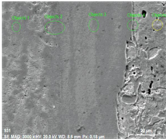
Şekil 3.10. S1 no'lu kaynaklı bağlantının kaynak bölgesindeki EDS analiz noktalarını gösteren SEM görüntüsü
