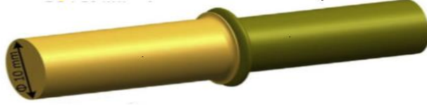
Şekil 1.4. Sürtünme kaynağı sonrasındaki flanş oluşumu
