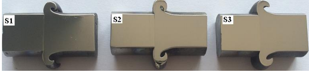
Şekil 3.3. S1, S2 ve S3 no'lu kaynaklı bağlantıların makro ve kaynak ara yüzey görüntüleri
