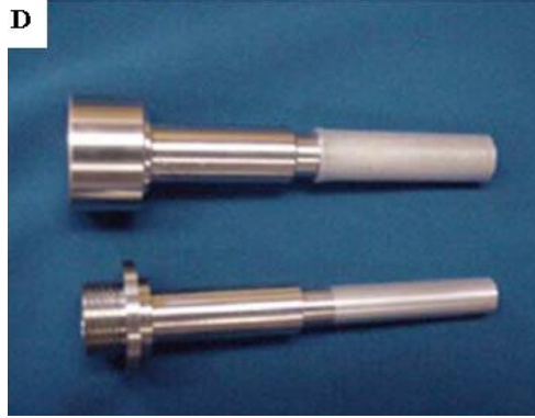
Şekil 1.11. a-) Ticari helikopter rotor gövdesi-2024 Alüminyum alaşımı, b-) Roket yakıt sisteminde kullanılan geçiş bağlantıları, c-) Mars lander basınç depo fittingsleri (6-4 Titanyum/6061-T6 Alüminyum), d-) MK 48 ateşleyici montajı (AISI 304 Paslanmaz/6061-T6 Alüminyum) [38]
