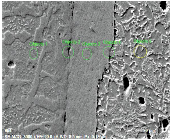
Şekil 3.38. S8 no'lu kaynaklı bağlantının kaynak bölgesindeki EDS analiz noktalarını gösteren SEM görüntüsü
