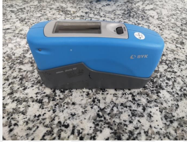
Şekil 3.10. Parlaklık ölçüm cihazı.
