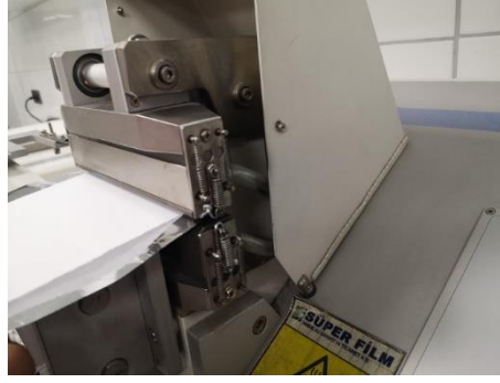
Şekil 3.15. Isıl yapışma cihazı.
