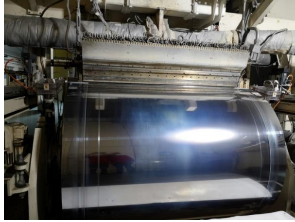
Şekil 3.4. Kalıp ve Chill Roll ünitesi.
