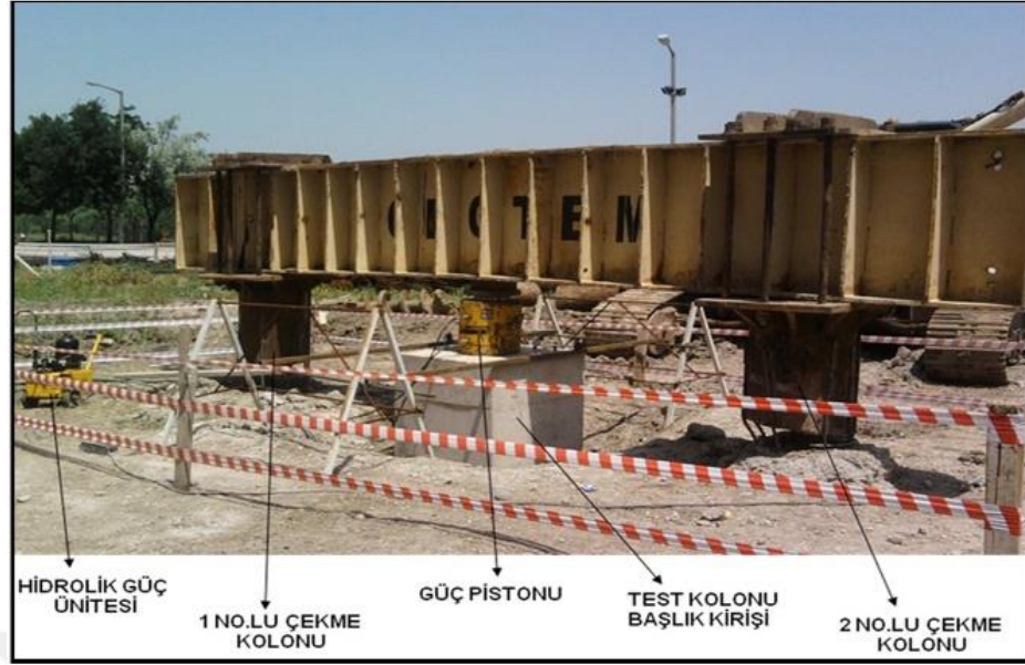
Şekil 3.19. Basit kolon yükleme deneyi (Tachir, 2015).
