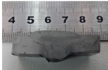
Şekil 6.5. Metalografik inceleme numunelerinin ebatlanması.
