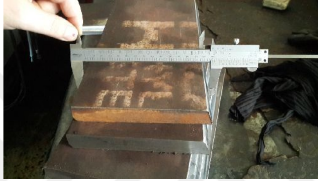
Şekil 5.1. Kaynak ağızı ve ebatlama.
