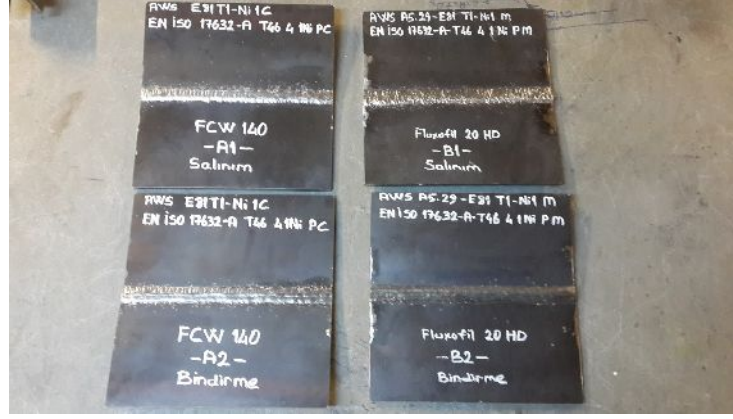
Şekil 5.8. Farklı kaynak uygulaması.
