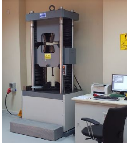
Şekil 6.7. TS EN ISO 4136 standardındaki 100 tonluk çekme deneyi cihazı.
