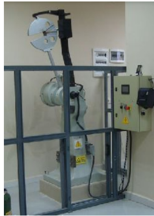
Şekil 6.9. Alşa darbe test cihazı.
