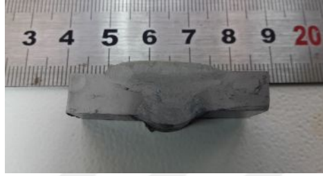
Şekil 7.21. Makro inceleme numunesi.
