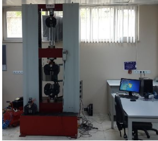
Şekil 6.8. DÜBİT Besmak marka 50 tonluk çekme deneyi cihazı.
