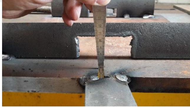
Şekil 5.2. Kaynak kök boşluğu.
