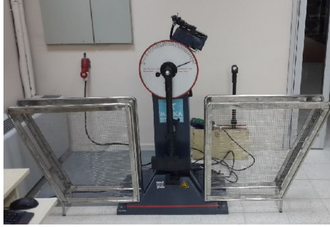
Şekil 6.10. Time Group Pendulum Impact test cihazı.
