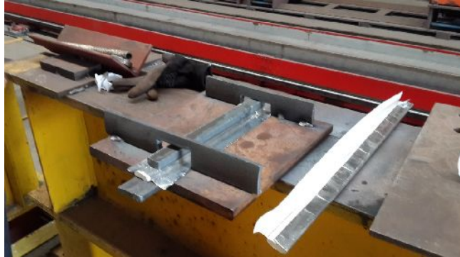
Şekil 5.3. Seramik altlık ve takviyeler.
