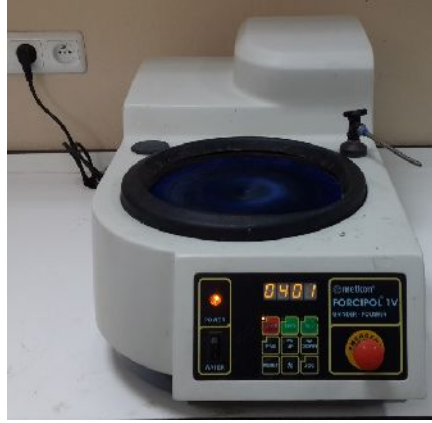
Şekil 6.6. Metkon Forcipol 1V parlatma cihazı.
