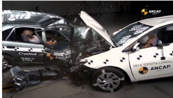
Şekil 3.1. 1998 model ile 2015 model Toyota Corolla'nın çarpma testi [35].
