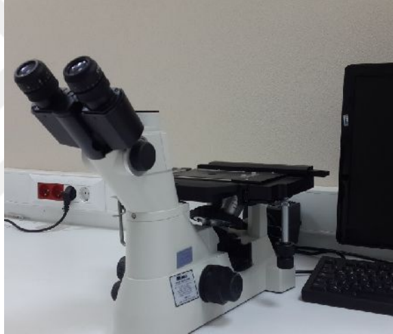
Şekil 6.12. Nikon Eclipse MA100 mikro yapı görüntüleme cihazı.
