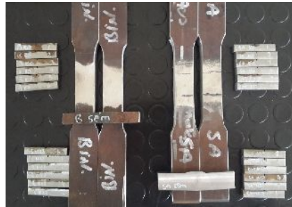
Şekil 6.2. Çekme ve çentik darbe numuneleri.
