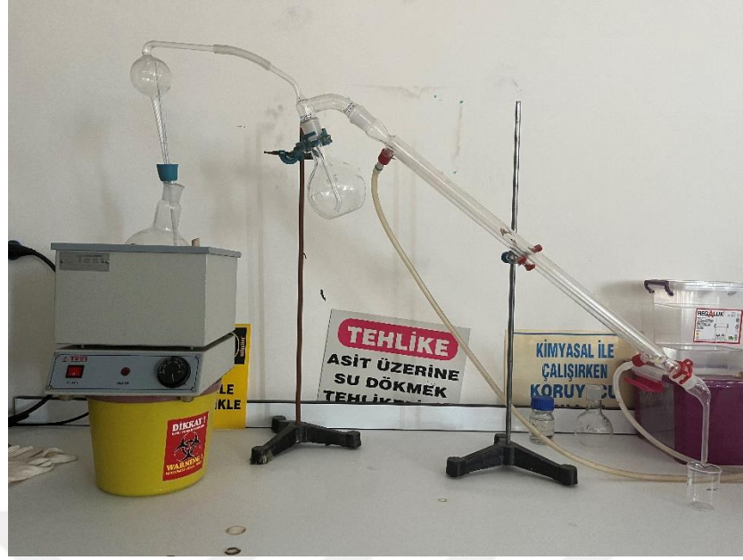
Şekil 3.5. UOA analizinde kullanılan distilasyon düzeneği
