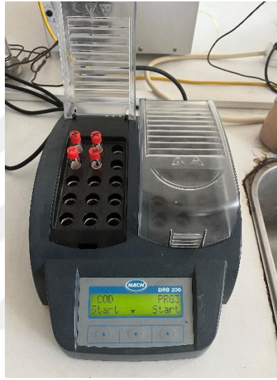
Şekil 3.4. Lange LT200 ısıtıcı blok ile KOİ analizi
