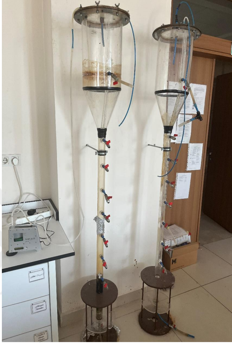
Şekil 3.3. UASB sisteminin boş görünümü
