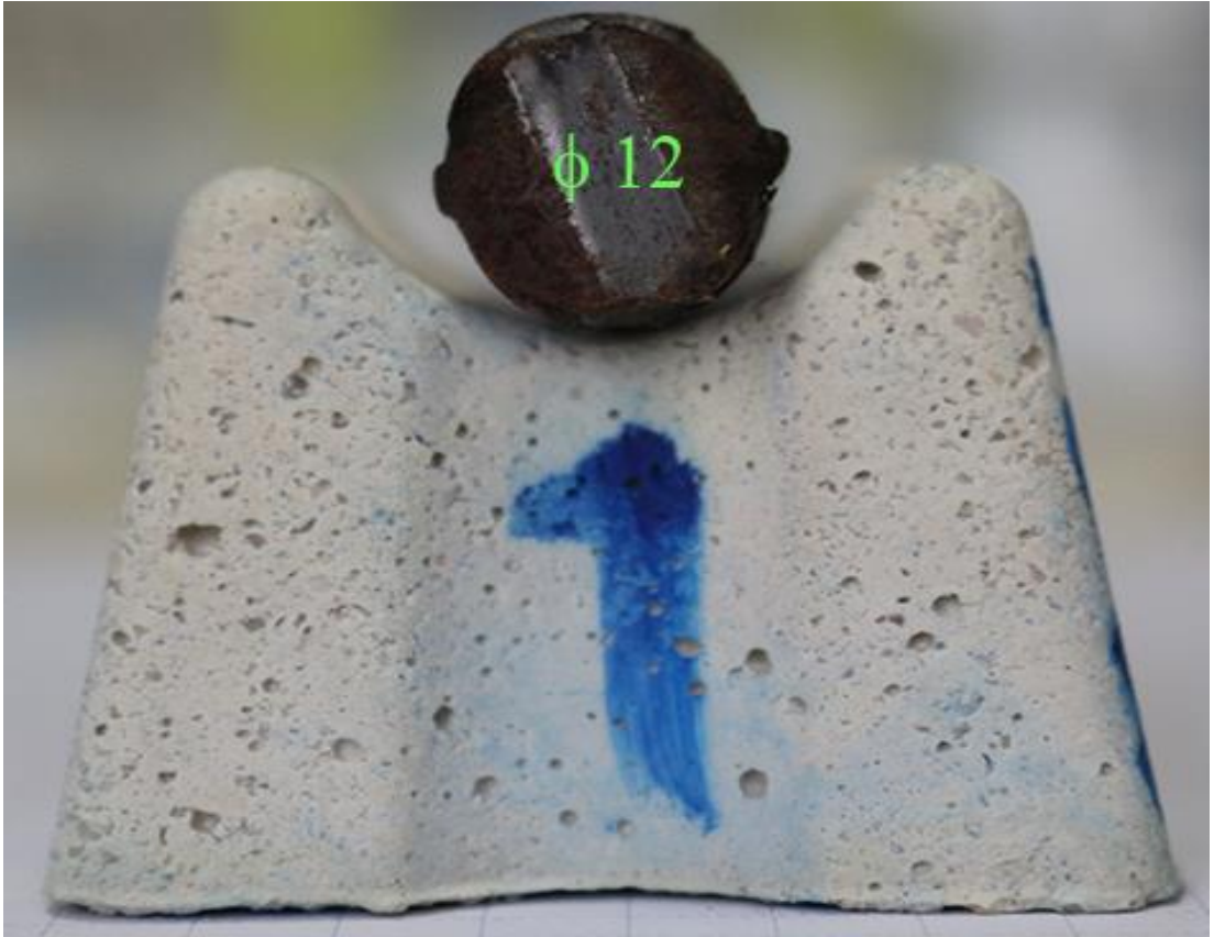
Şekil 2.4. Beton paspayına donatı yerleşimi.
