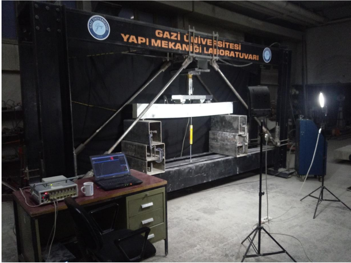
Resim 4.3. Betonarme kirişlerde ölçüm düzeni
