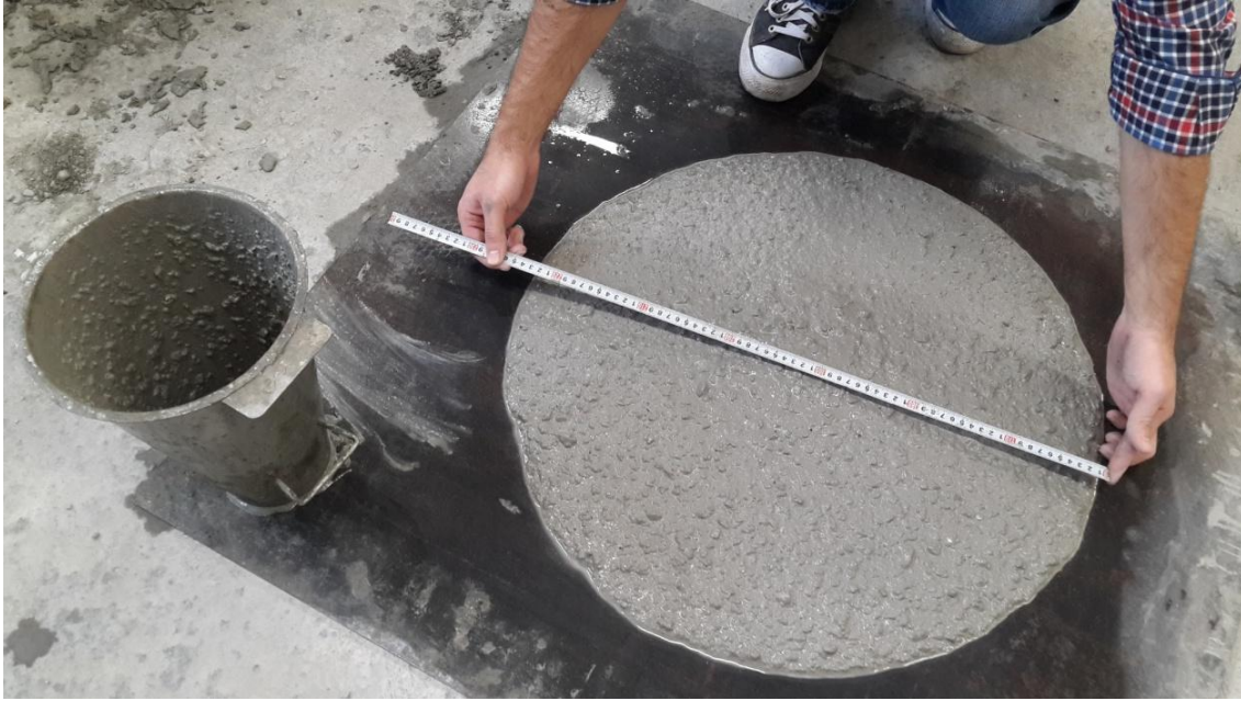
Şekil 2.2 : Çökme-Akma deney düzeneği
