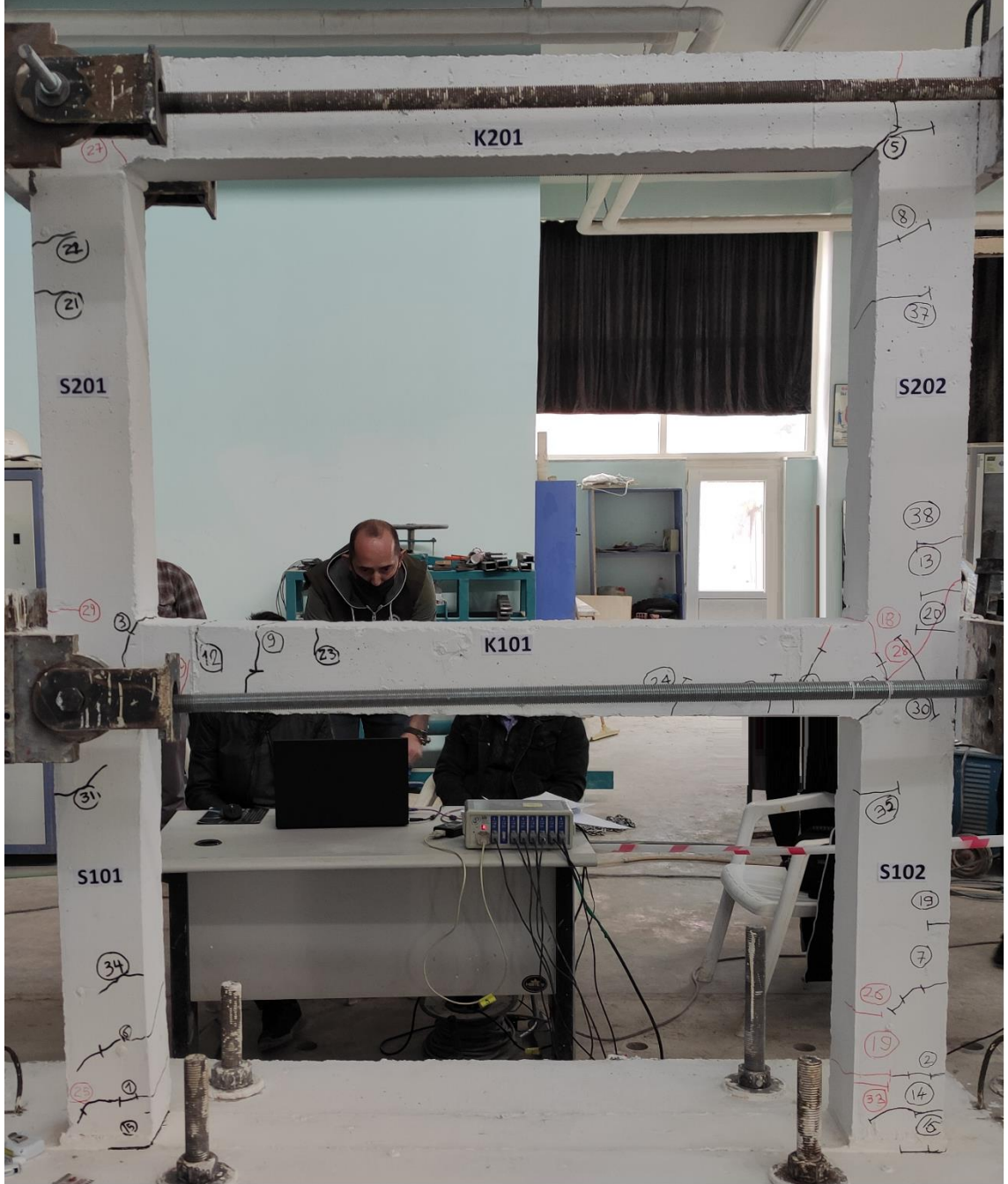
Şekil 4.7. 1 nolu deney numunesinin akma anındaki görünümü
