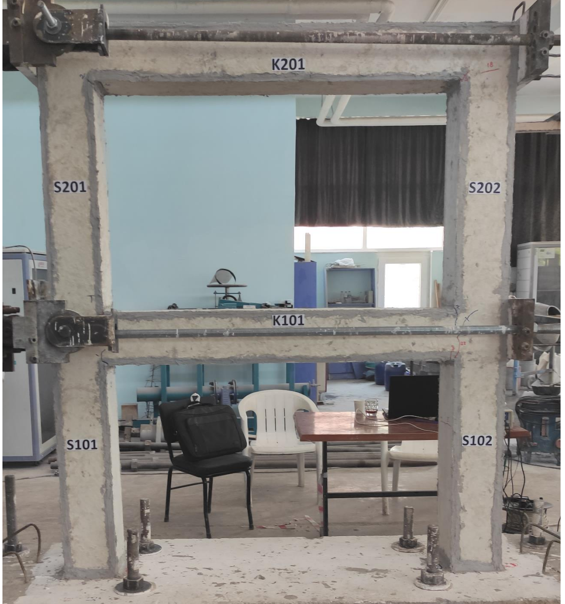
Şekil 4.97. 7 nolu deney numunesinin akma anındaki görünümü
