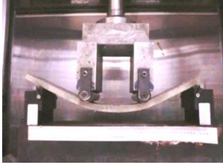
Şekil 2.1. Eğilme testinde oluşan büyük deformasyon (Zhang ve ark., 2014)
