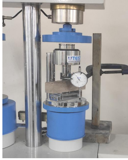
Şekil 3.10. Eğilme dayanımı testi
