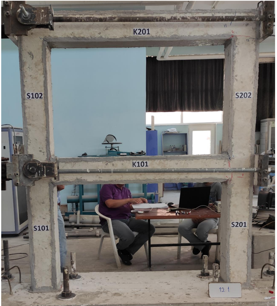
Şekil 4.82. 6 nolu deney numunesinin akma anındaki görünümü
