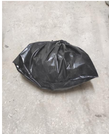
Şekil 3.9. Numunelerin özel poşet içinde kür edilmesi
