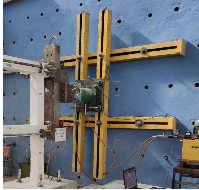
Şekil 3.29. Yük ölçüm düzeneği
