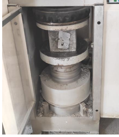
Şekil 3.23. Beton basınç dayanımı deneyi
