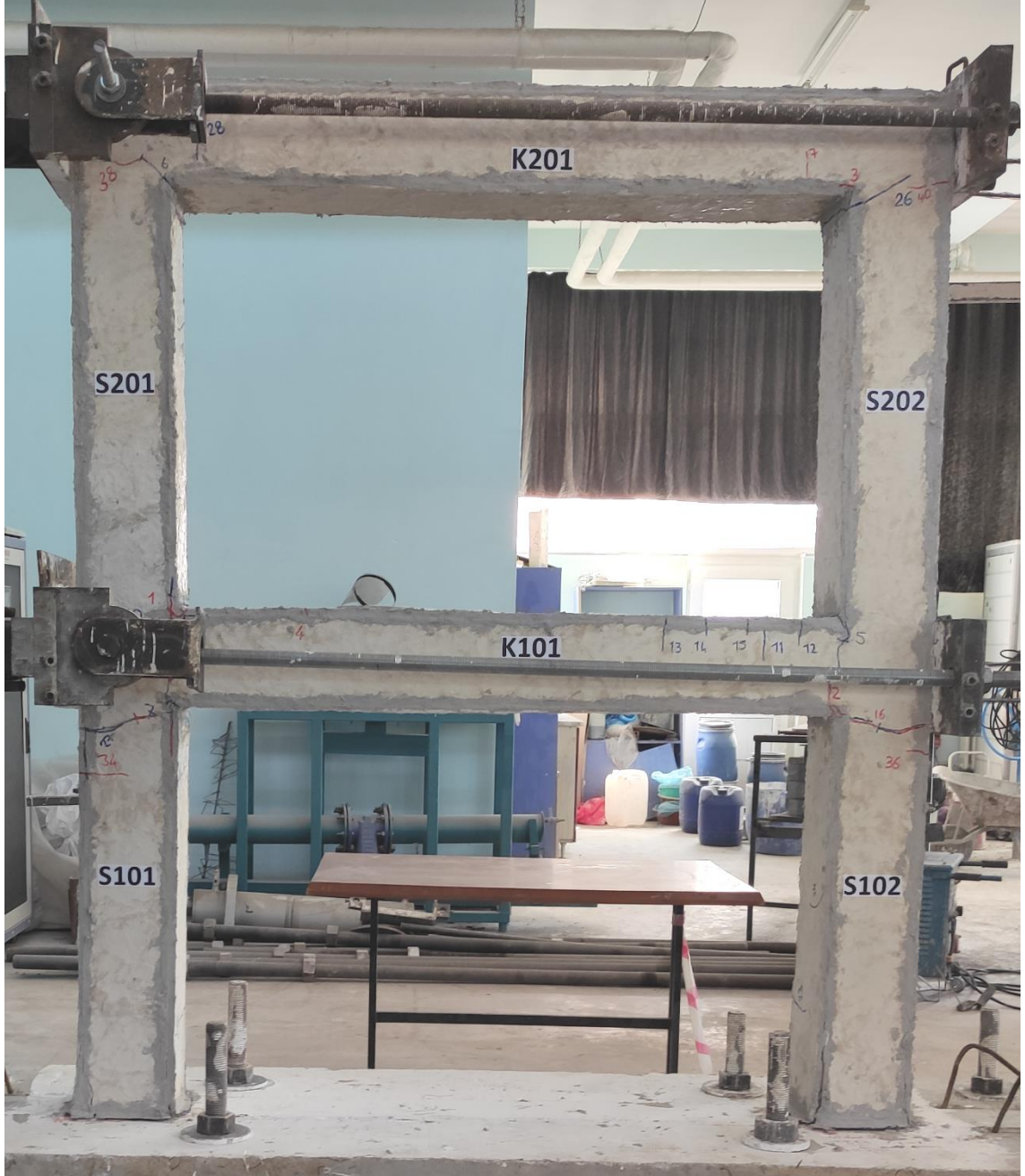
Şekil 4.68. 5 nolu deney numunesinin deney sonrasındaki görünümü
