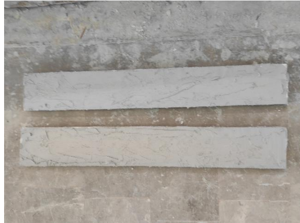
Şekil 3.27. Panellere yapıştırıcı malzemenin uygulanması
