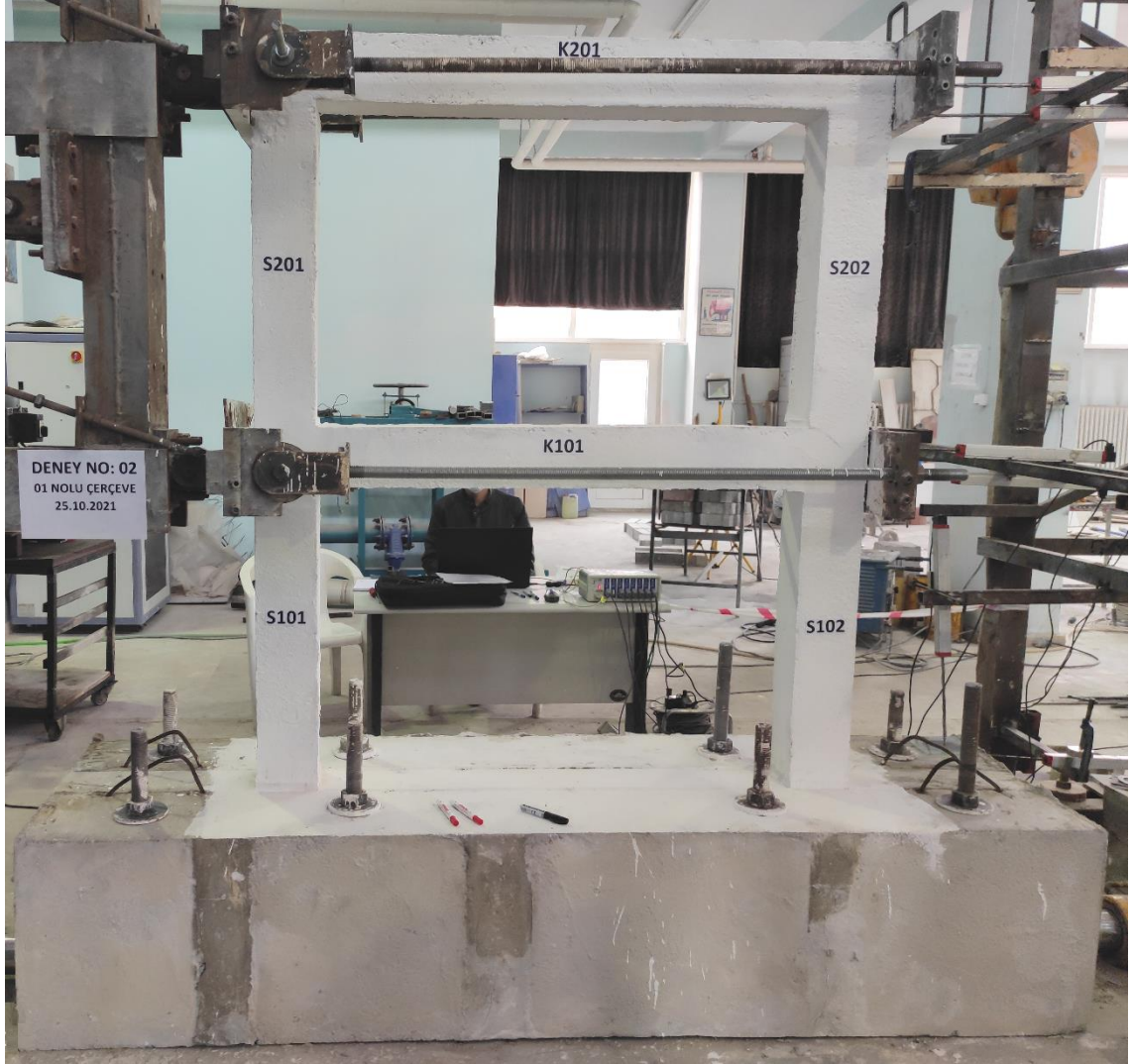
Şekil 4.20. 2 nolu deney numunesinin deneyden önceki görünümü
