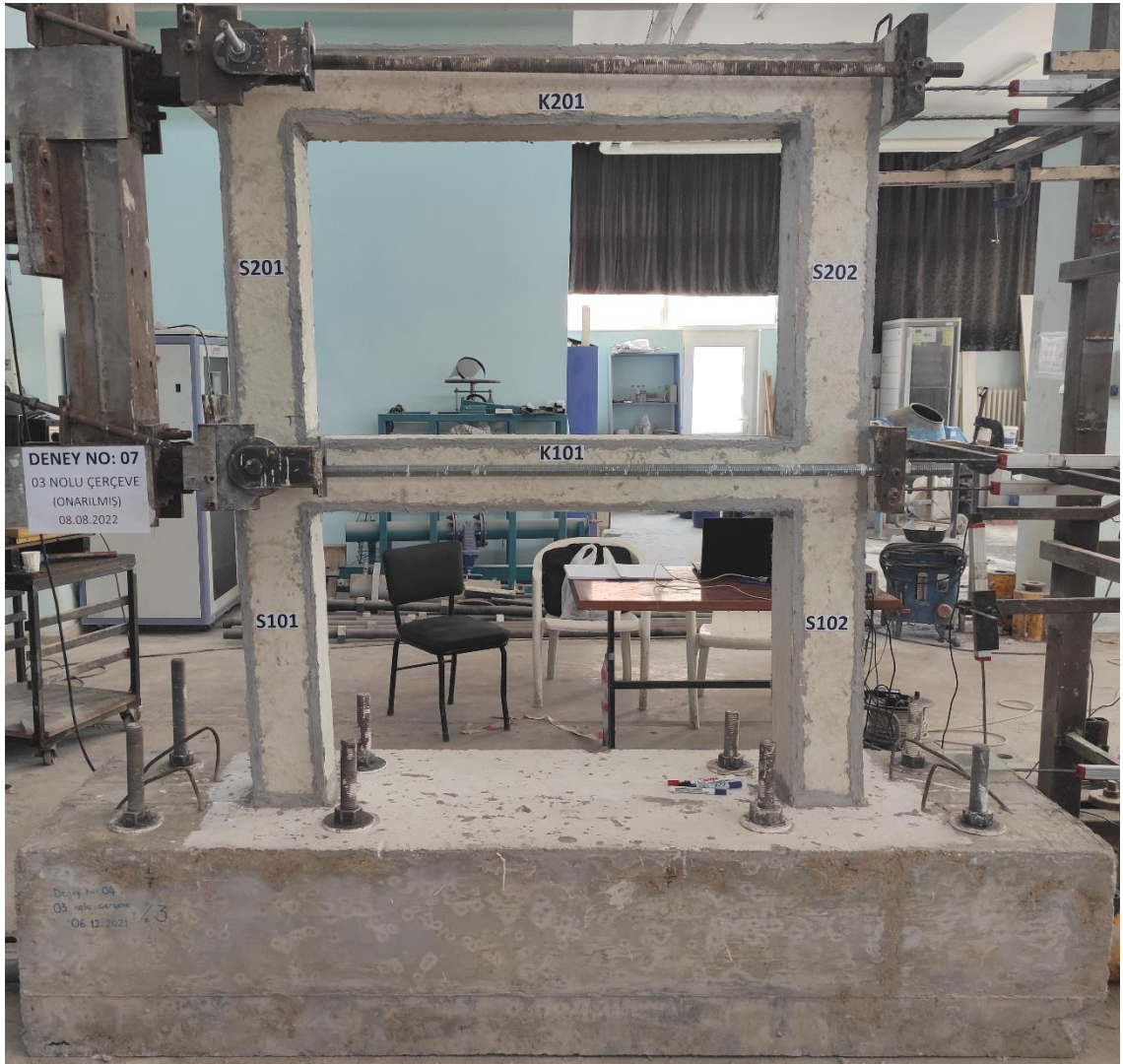
Şekil 4.93. 7 nolu deney numunesinin deneyden önceki görünümü
