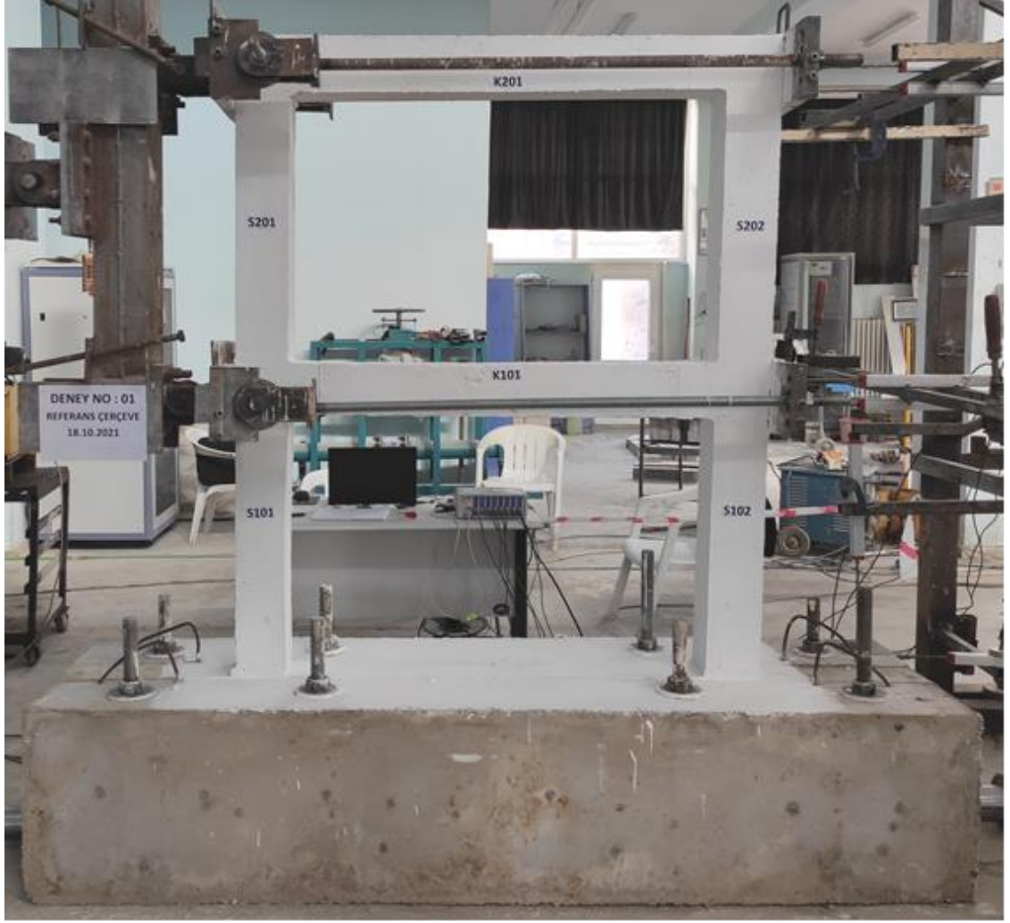
Şekil 4.3. 1 nolu deney numunesinin deneyden önceki görünümü
