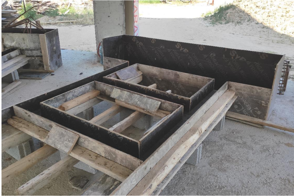
Şekil 3.18. Çerçeve numunelerinin kalıbının hazırlanması
