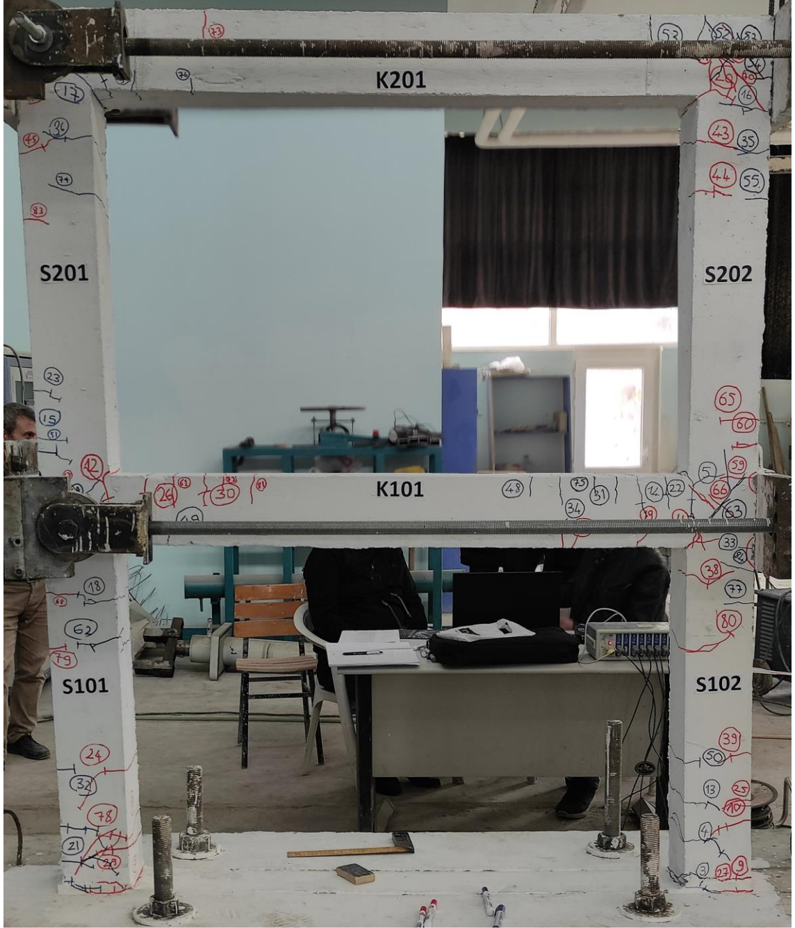
Şekil 4.39. 3 nolu deney numunesinin deney sonrasındaki görünümü
