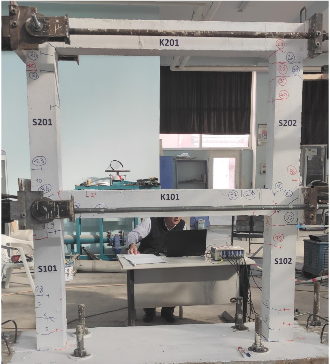
Şekil 4.53. 4 nolu deney numunesinin akma anındaki görünümü
