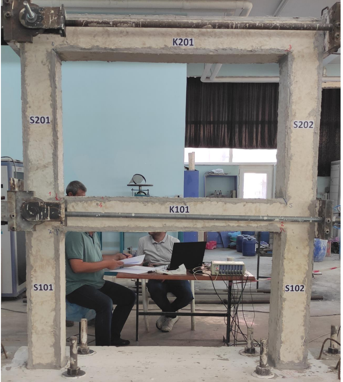
Şekil 4.67. 5 nolu deney numunesinin akma anındaki görünümü
