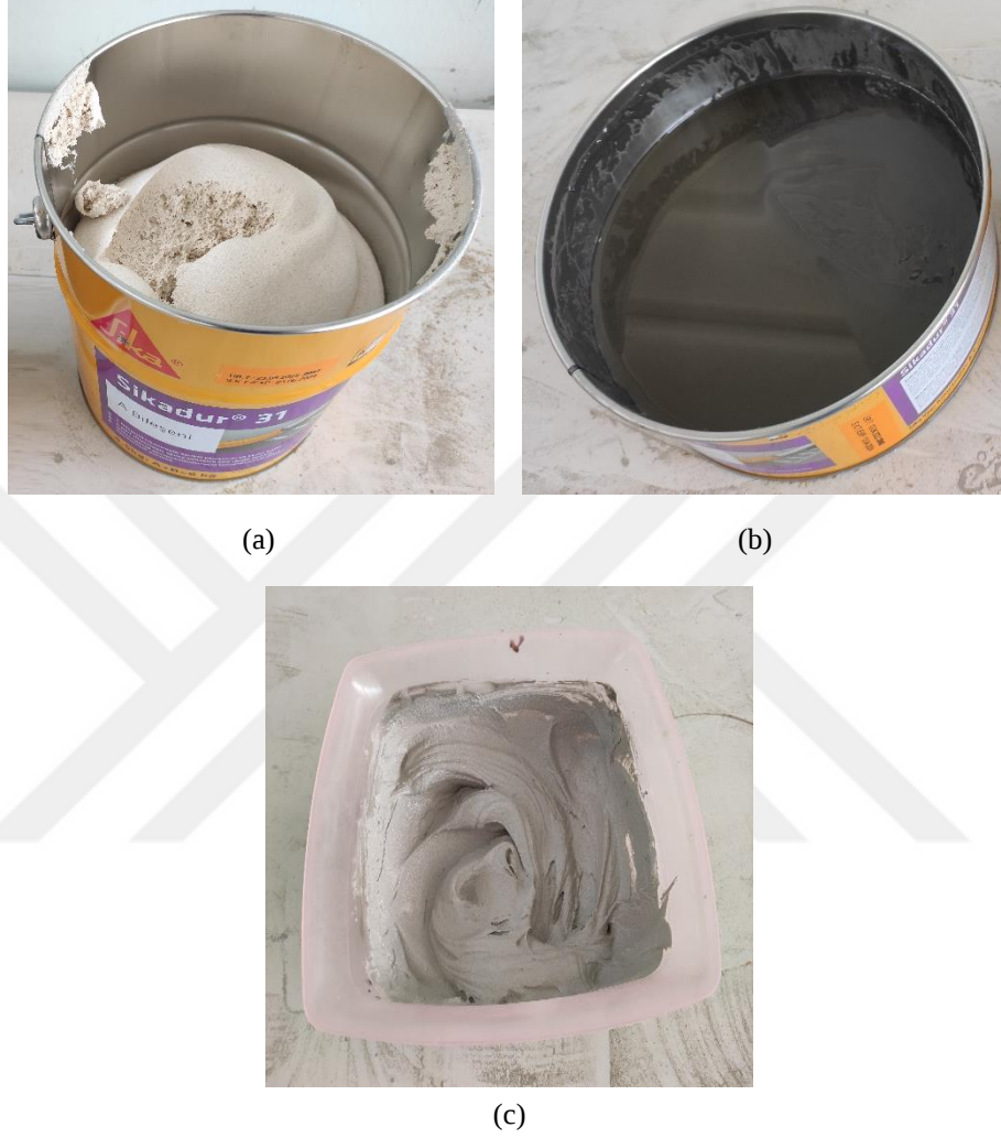
Şekil 3.26. Yapıştırıcı malzemenin görünümü (a) A bileşeni, (b) B bileşeni, (c) Karışımı
