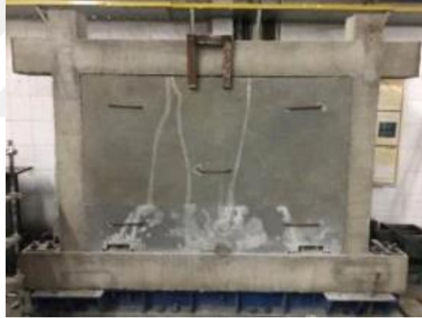
Şekil 2.2. Numunenin güçlendirmeden sonraki görünümü (Ahmadi ve Nateghi-Alahi, 2022)
