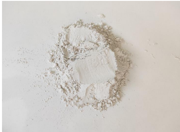
Şekil 3.3. Öğütülmüş yüksek fırın cürufunun görünümü
