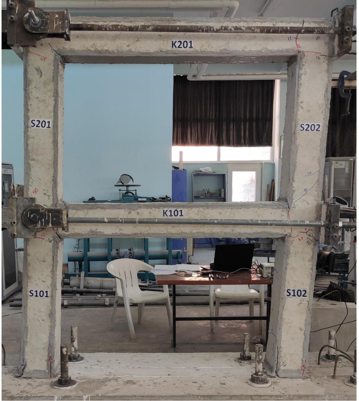
Şekil 4.83. 6 nolu deney numunesinin deney sonrasındaki görünümü
