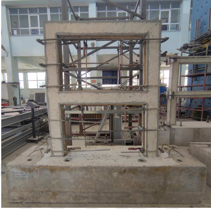
Şekil 3.28. Betonarme çerçeveye yapıştırılan paneller
