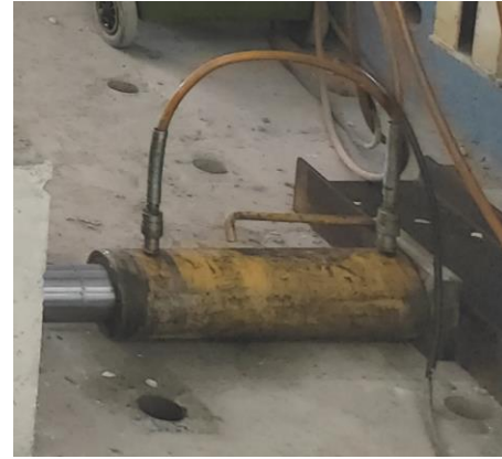
Şekil 3.31. Temelin iki yanına yerleştirilen hidrolik silindirler
