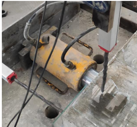
Şekil 3.31. Temelin iki yanına yerleştirilen hidrolik silindirler
