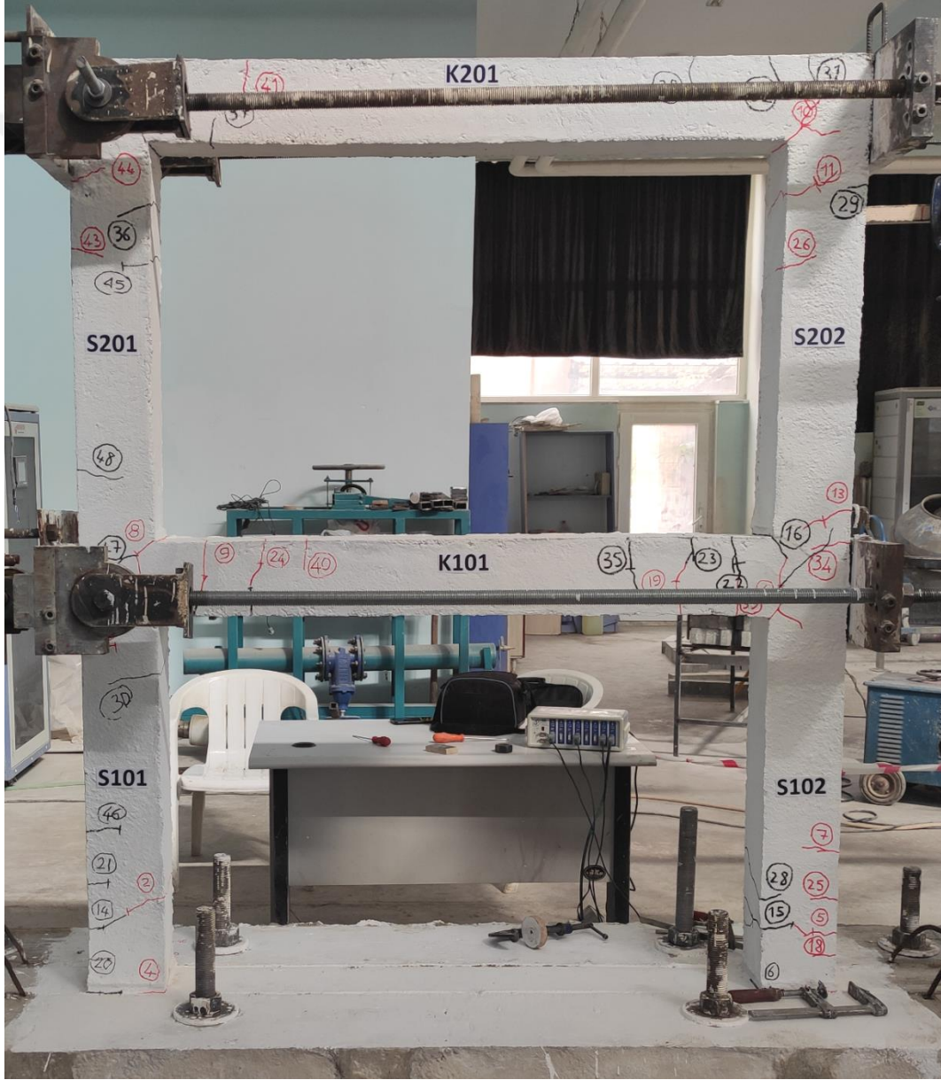
Şekil 4.24. 2 nolu deney numunesinin deney sonrasındaki görünümü
