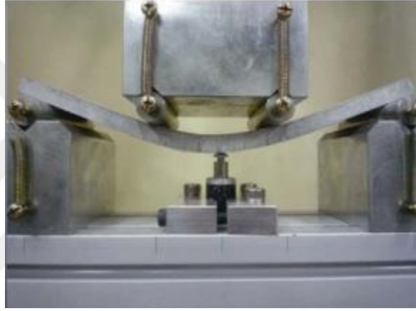
Şekil 1.2. ECC kompozitin eğilme yükleri altındaki sünek davranışı (Lim ve ark., 2012)
