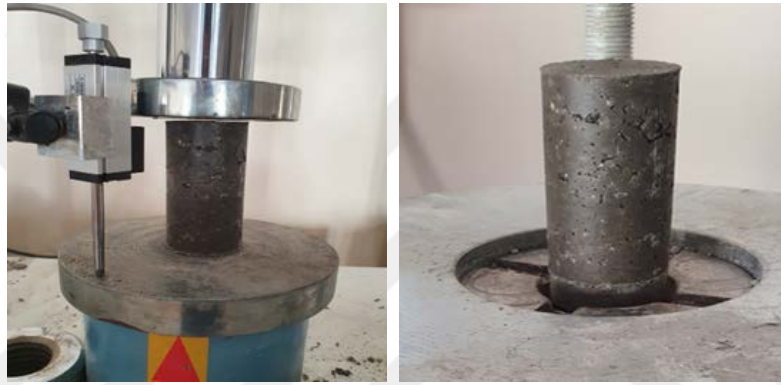
Şekil 8. Tek eksenli basınç deneyine ait numune örnekleri.
