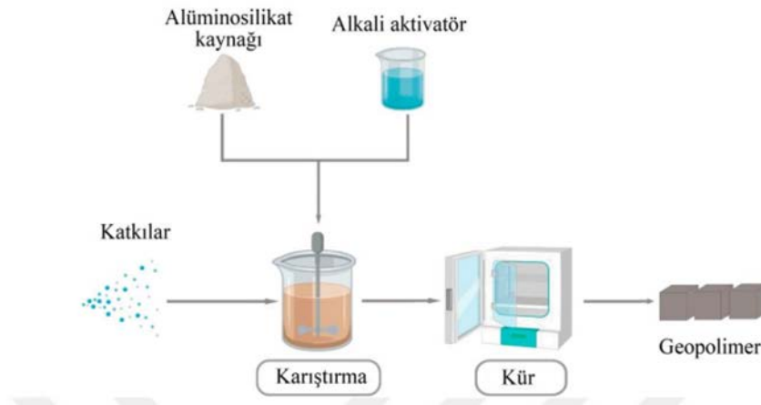
Şekil 2. Geopolimer oluşumunun şematik diyagramı (Yegin, 2020).
