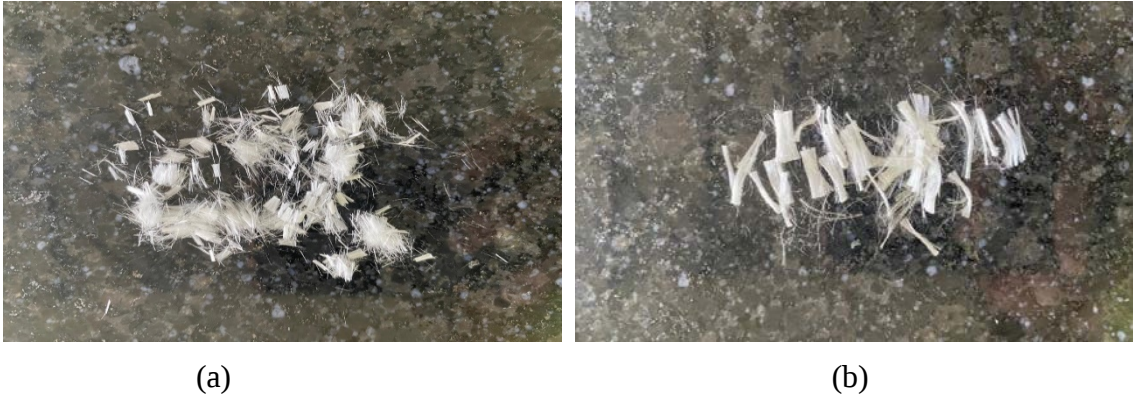
Şekil 7. Mikro sentetik fiber donatı. a) 3 mm, b) 12 mm
