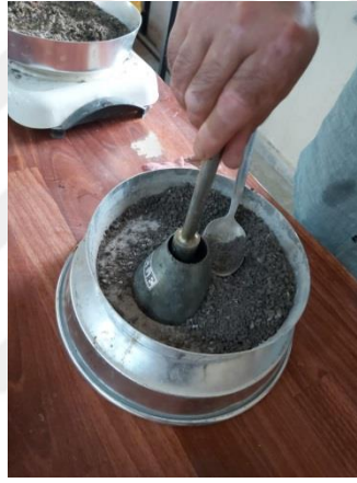
Şekil 9. İnce agreg özgül ağırlık deney aşamaları
