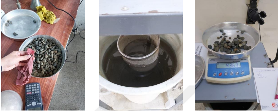
Şekil 10. İri agrega özgül ağırlık deney aşamaları
