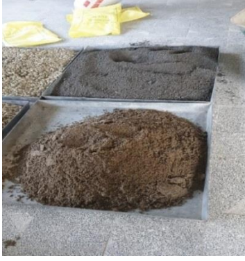
Şekil 7. Betonda kullanılan iri agrega ve ince agregalar
