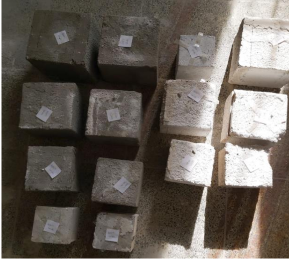
Şekil 19. 450°C'ta 60 dakika bekletilen sıvasız ve sıvalı numuneler
