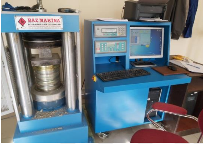
Şekil 16. Basınç dayanımı deneyi
