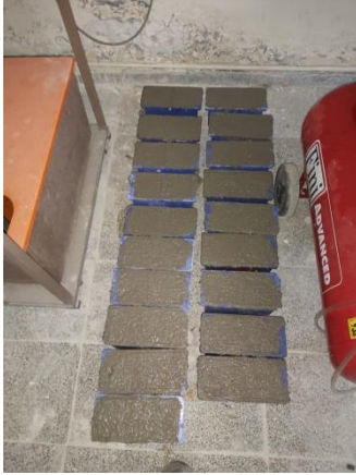
Şekil 13. Deneyler için hazırlanan küp numuneler
