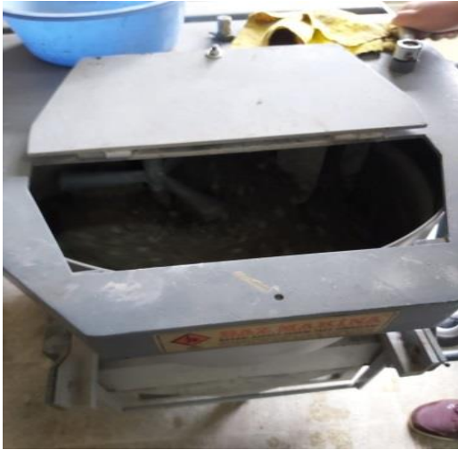
Şekil 11. Betonun Pan tipi mikserde karılması
