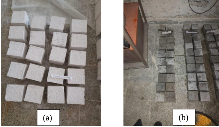
Şekil 14. a) Isı yalıtım sıvası ile hazırlanan numuneler b) Normal sıvayla hazırlanan numuneler
