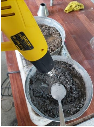
Şekil 9. İnce agreg özgül ağırlık deney aşamaları
