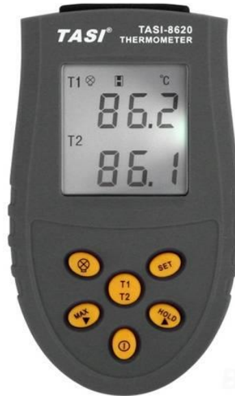
Şekil 4.3. K tipi çift giriş termometre [81]
