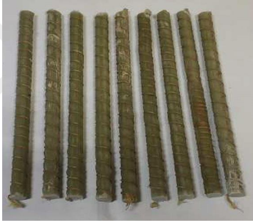
Şekil 4.2. 10 mm çapında FRP bar [79]
