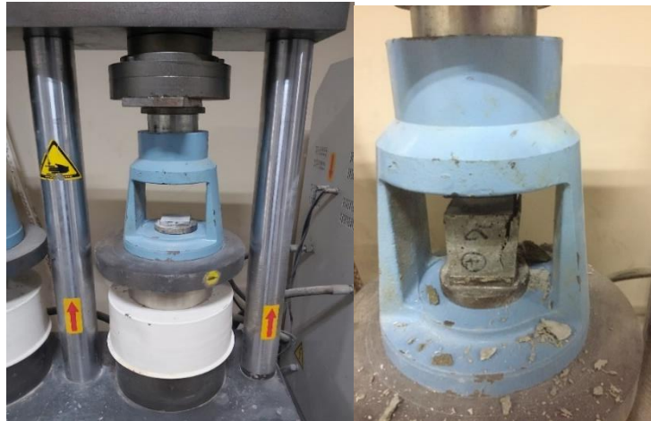
Şekil 21. Basınç dayanımı testinin küp numunelerde uygulanması.
