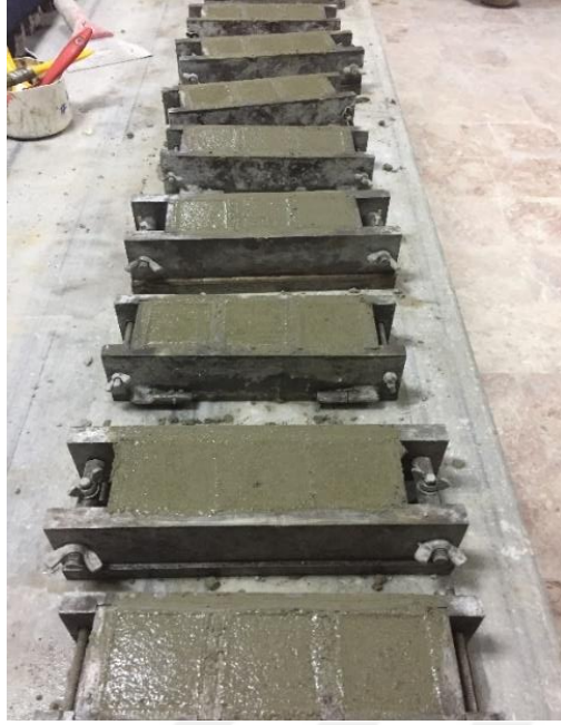
Şekil 13. 50 × 50 × 50 mm küp kalıplara dökülen numuneler.
