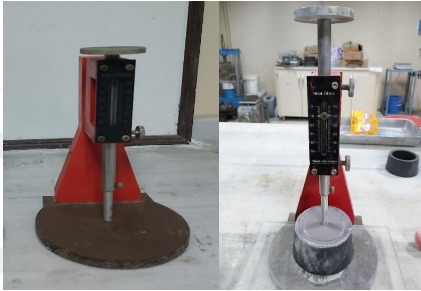
Şekil 17. Vicat aleti ve kıvam tayini yapılan numune.
