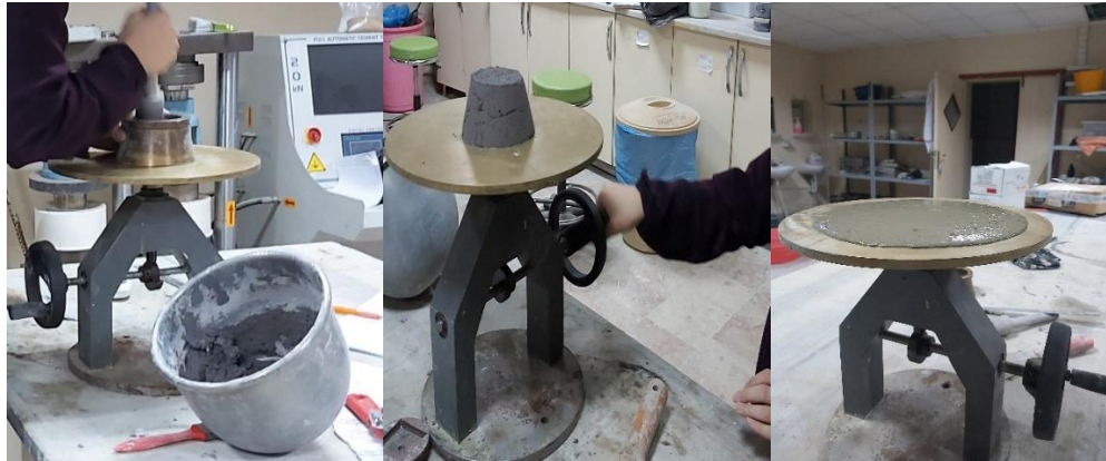
Şekil 19. Yayılma tablası deneyinin yapılışı.
