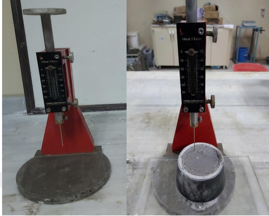
Şekil 18. Vicat aleti ve priz başlangıç ve bitiş deneyi yapılan numune.
