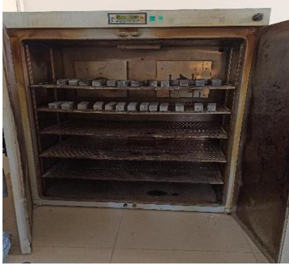
Şekil 3.13. Yüksek sıcaklık fırını ve numunelerin yerleştirilmesi
