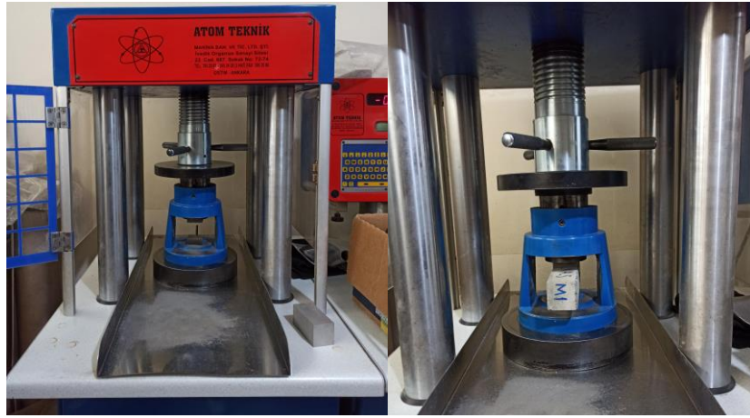
Şekil 3.11. Beton press makinesi ve basınç dayanımı tayini
