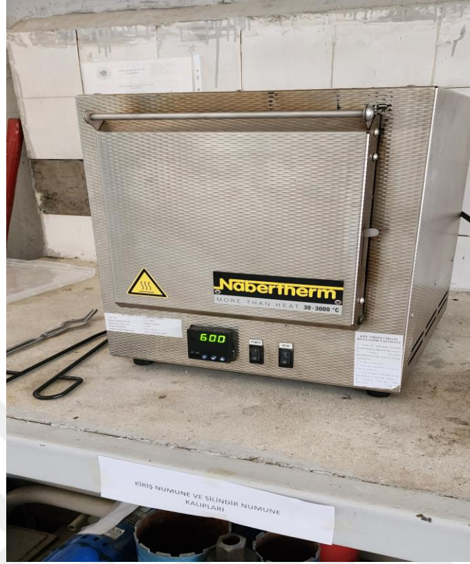
Şekil 3.10. Hazırlanan beton karışımlarının ısıtılma tabi tutulması
