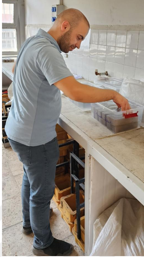
Şekil 3.11. Numunelerin ilgili kür havuzlarına bırakılması
