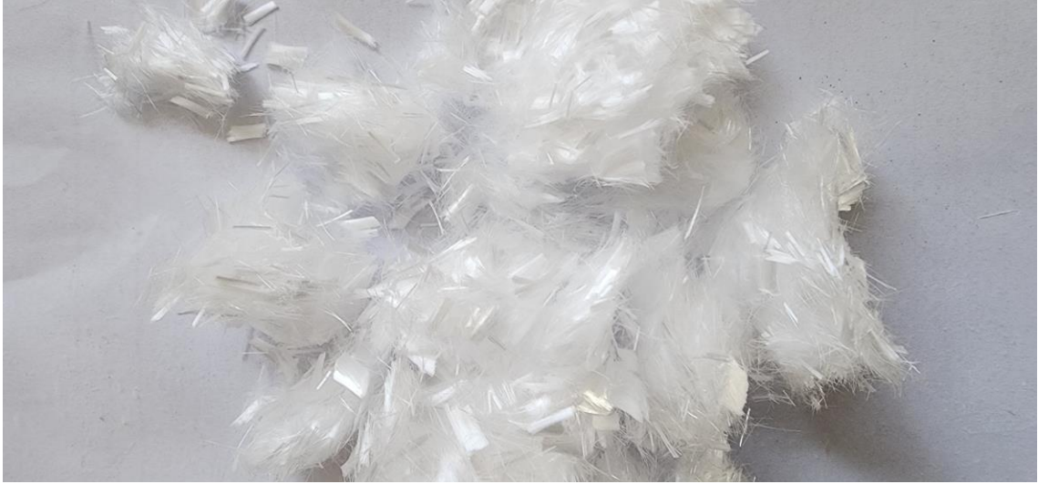
Şekil 3.3. Deney esnasında kullanılan polipropilen life ait görsel
