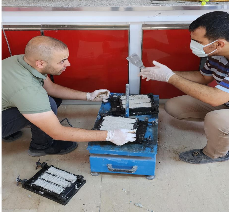
Şekil 3.8. Hazırlanan beton karışımlarının kalıp içerisindeki vibrasyon işlemi
