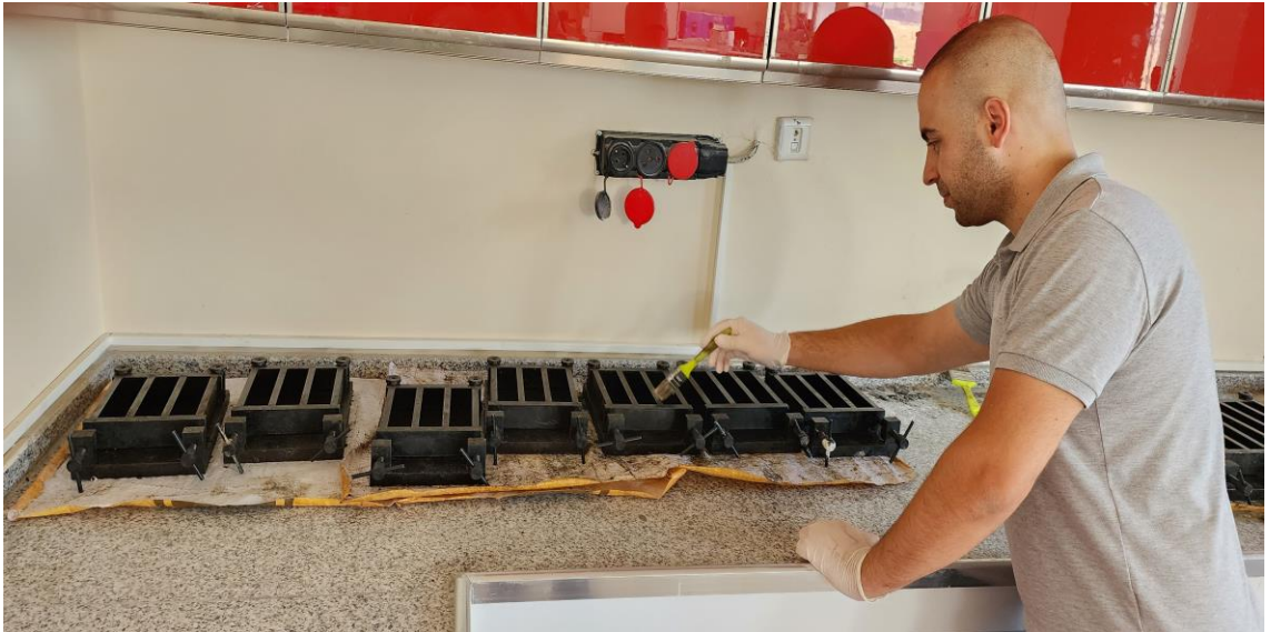
Şekil 3.7. Hazırlanan beton karışımlarına ait kalıplar ve yağlama prosedürü
