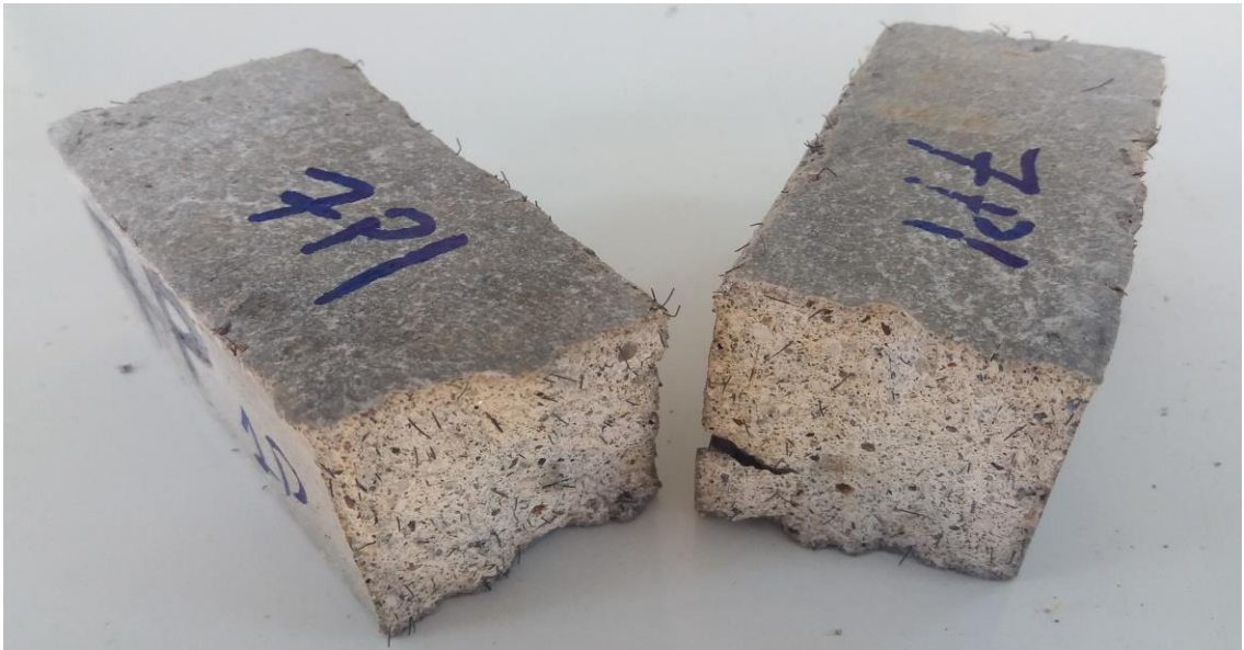
Şekil 3.13. Basınç testine tabi tutulmuş bir deney numunesi
