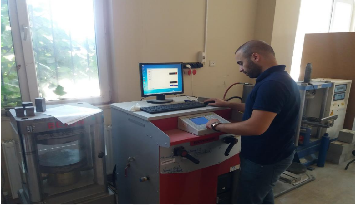
Şekil 3.12. Numunelerin ilgili kür yaşlarında basınç testi
