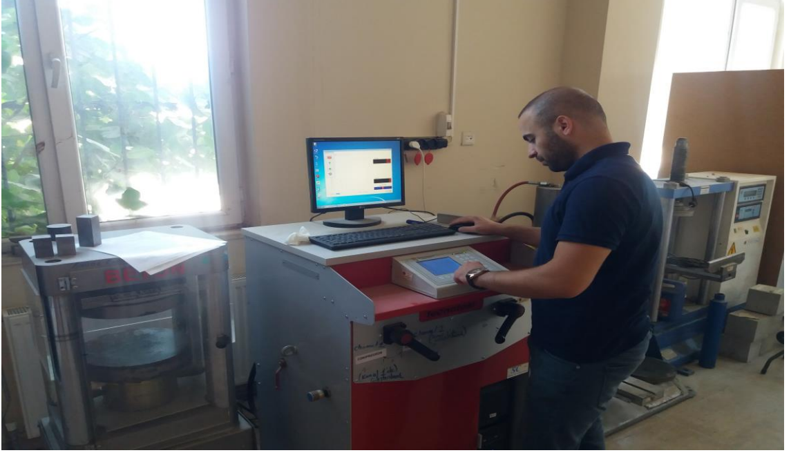
Şekil 3.12. Numunelerin ilgili kür yaşlarında basınç testi
