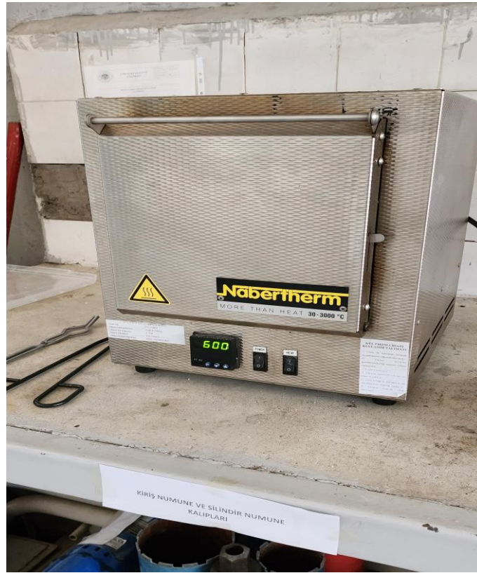
Şekil 3.10. Hazırlanan beton karışımlarının ısıtılma işlemine tabi tutulması
