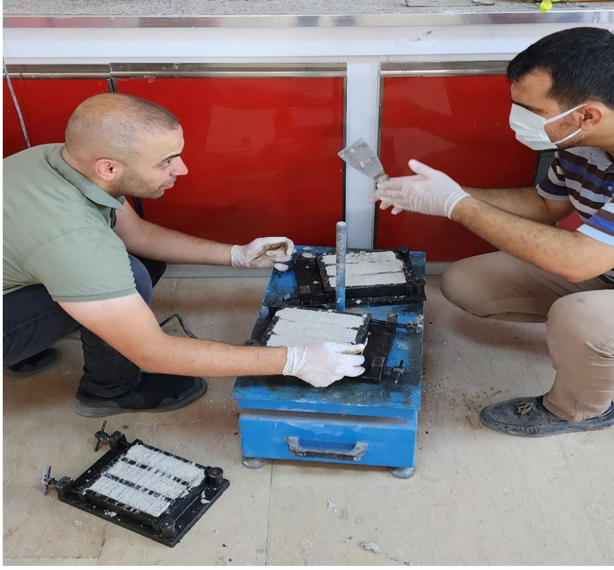
Şekil 3.8. Hazırlanan beton karışımlarının kalıp içerisindeki vibrasyon işlemi
