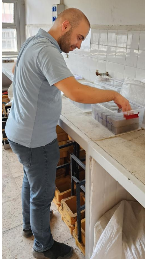
Şekil 3.11. Numunelerin ilgili kür havuzlarına bırakılması
