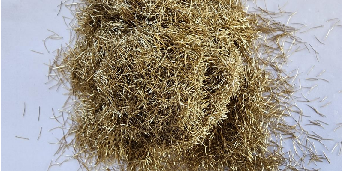
Şekil 3.2. Deney esnasında kullanılan ve 0.35 mm çapa sahip pirinç kaplı çelik life ait görsel
