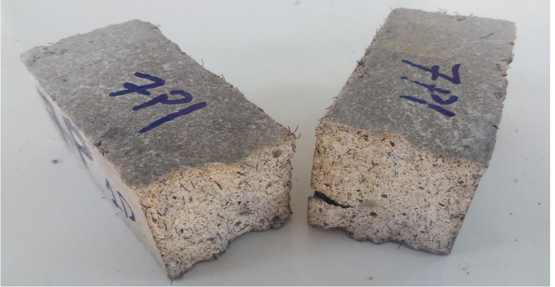
Şekil 3.13. Basınç testine tabi tutulmuş bir deney numunesi
